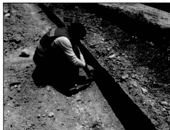
Toma de muestra en la pared de la caja o zona de extracción
