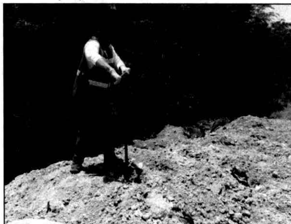
Se tomaron muestras en la celda de tratamiento a diferentes profundidades con hand auger de acero inoxidable
