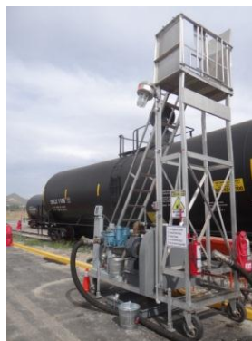
Figura 9. Ejemplo de Equipo Transloader para Trasvase de Diésel.
