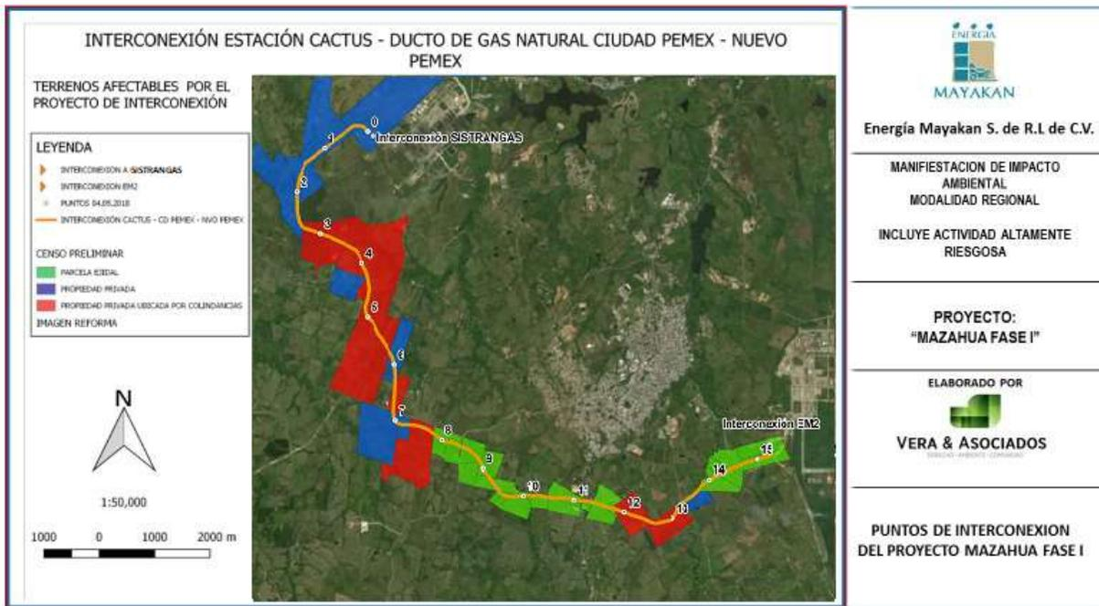
El Proyecto tendrá un punto de interconexión con el gasoducto de 48" D.N. Cactus – San Fernando en las coordenadas **UTM GS84, 478528.8982 E; 1978806.9787 O** y se dirigirá al sureste hasta el punto de interconexión con el Gasoducto Energía Mayakan en las coordenadas **486242.00 E; 1973373.00 O**, Zona 15.
