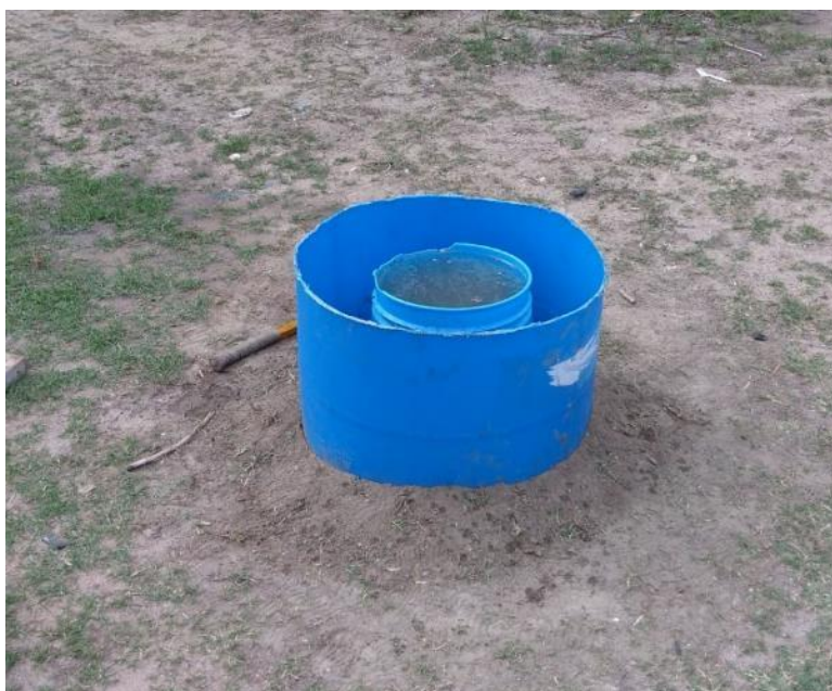
Figura 52 Realización de la prueba de infiltración número 6.
