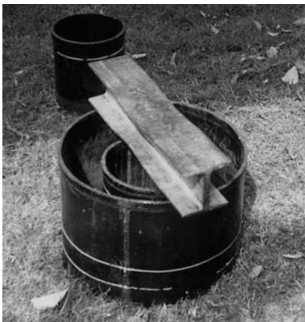
Figura 45 Infiltrómetro de doble anillo
