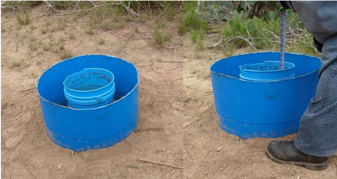
Figura 51 Realización de la prueba de infiltración número 5.
