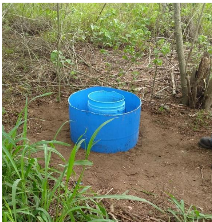
Figura 48 Realización de la prueba de infiltración número 3.
