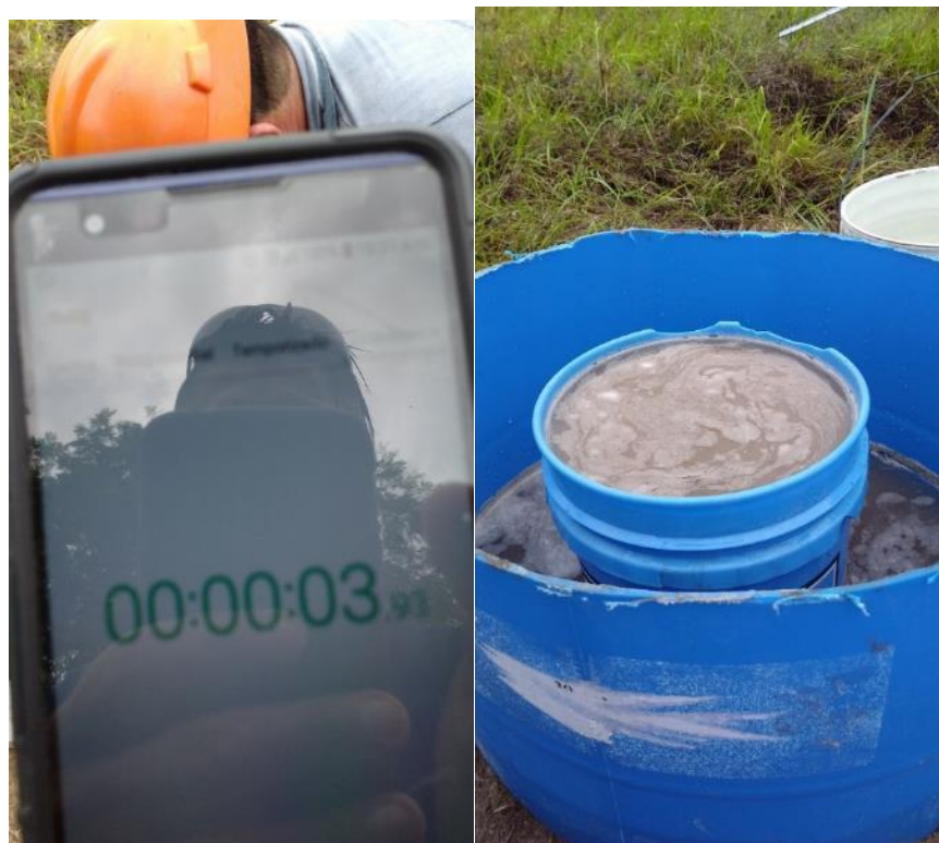
Figura 47 Realización de la prueba de infiltración número 1.
