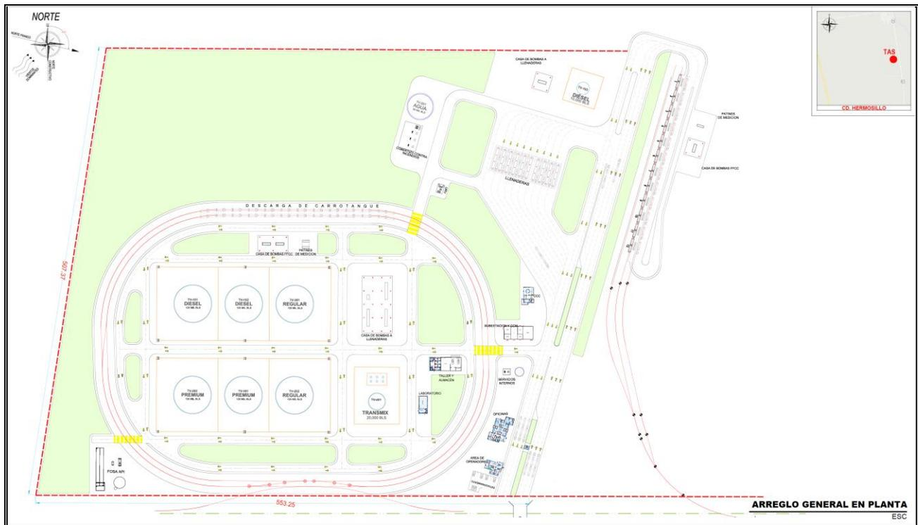
**Figura II. 3 Distribución de la infraestructura que conformará la TAS.**
