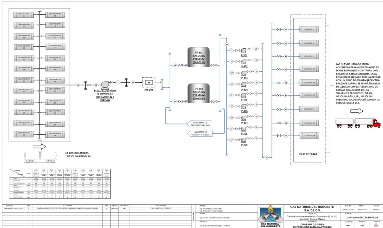
**Figura II. 11 Diagrama de Flujo operativo del manejo de Gasolina Premium.**
