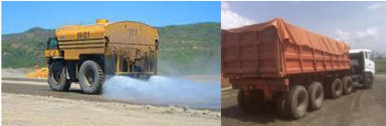
**Figura 6.9.** Ejemplos de medidas para el control de polvos y contaminantes.
