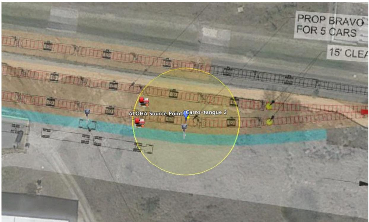
**Figura II.14 Radios de afectación Escenario 1 – Incendio - Fuga 25mm – Carro-tanque 1**
