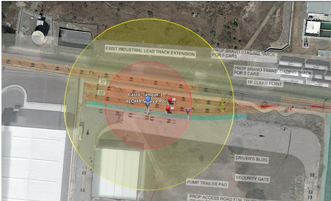
Figura IV.11 Radios de afectación Escenario 1 – Incendio - Fuga 100mm – Carro-tanque 1
