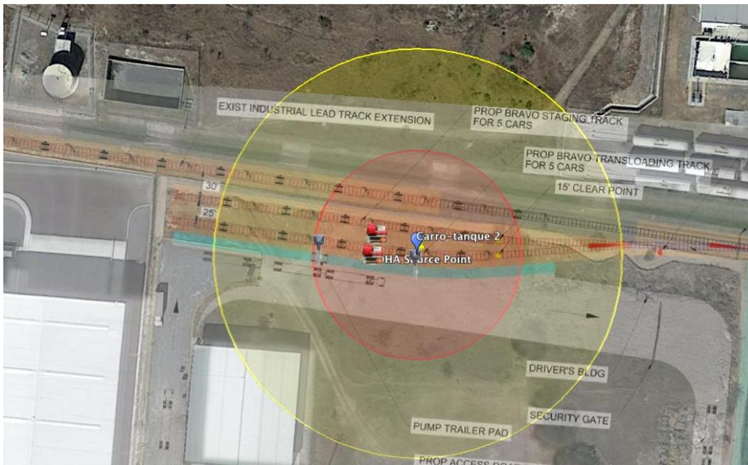
Figura II.12 Radios de afectación Escenario 1 – Incendio - Fuga 100mm – Carrotanque 2
