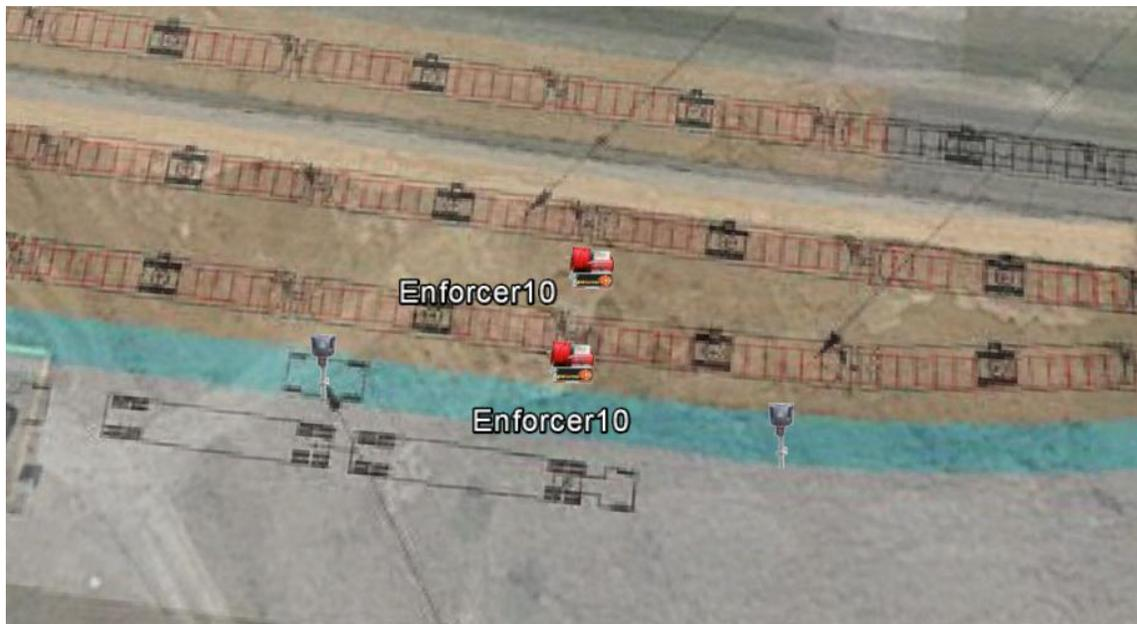
**Figura I.2 Ubicación de los equipos contra incendio Enforcer 10 durante el proceso de trasvase**
