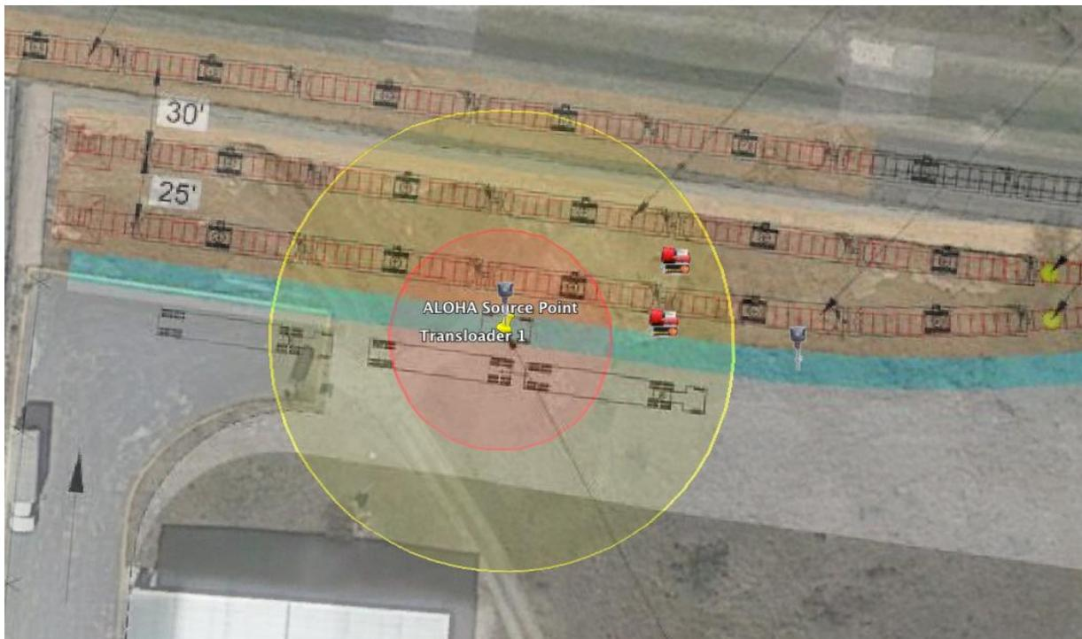
**Figura II.15 Radios de afectación Escenario 2 – Incendio - Derrame – Transloader 1**
