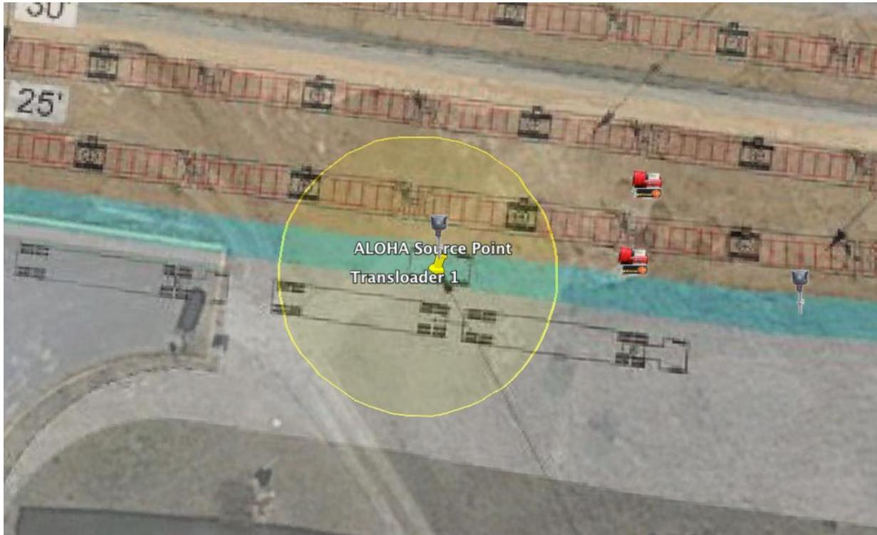
Figura II.17 Radios de afectación Escenario 3 – Incendio - Fuga 25mm – Transloader 1
