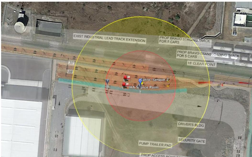
Figura IV.12 Radios de afectación Escenario 1 – Incendio - Fuga 100mm – Carro-tanque 2
