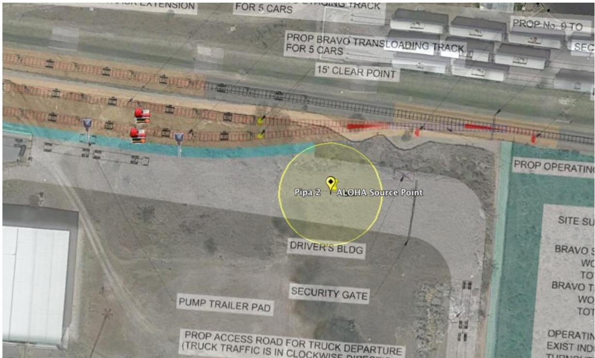
**Figura IV.22 Radios de afectación Escenario 4 – Incendio - Fuga 25mm – Auto-tanque 2**
