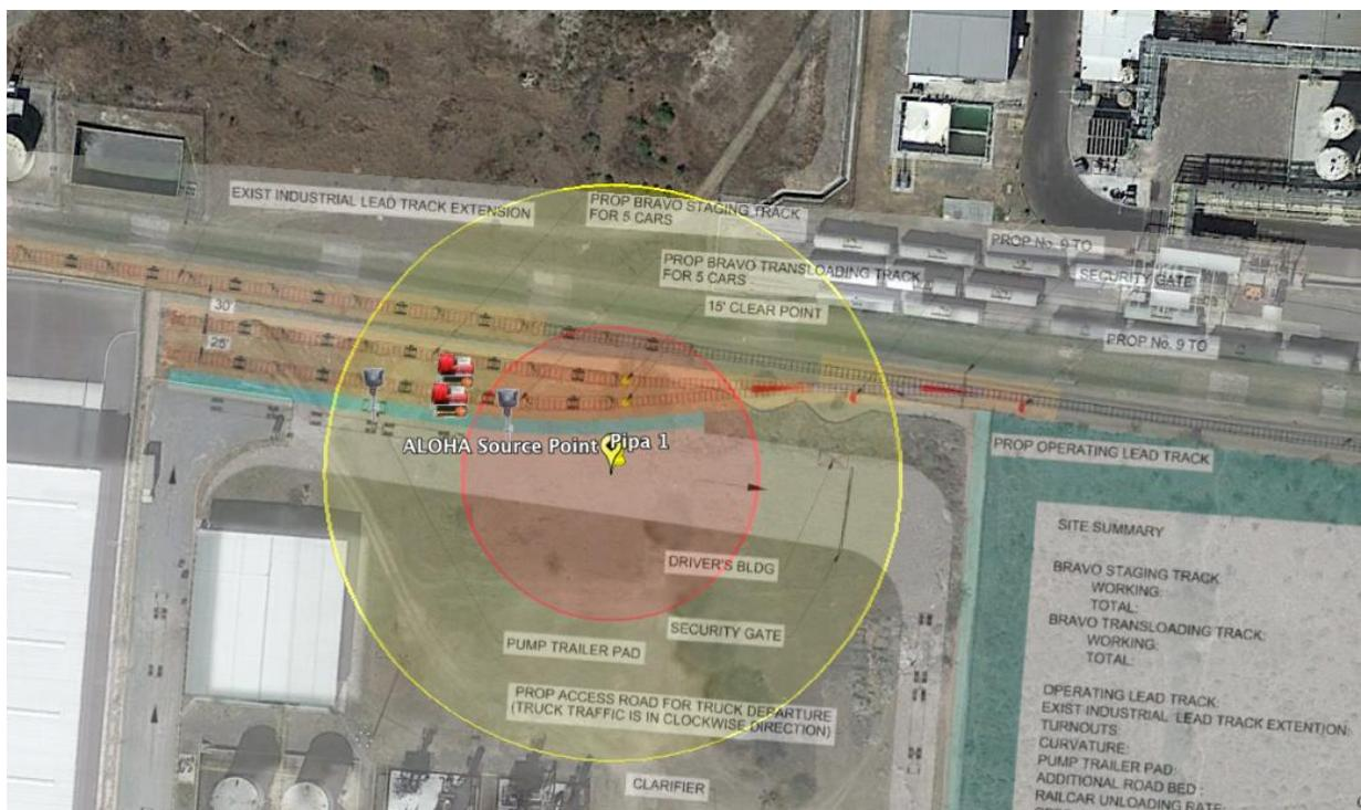
Figura IV.19 Radios de afectación Escenario 4 – Incendio - Fuga 100mm – Auto-tanque 1
