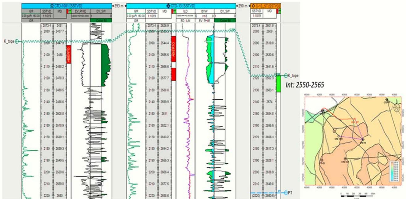
**FIGURA. III.1.9.2 CORRELACIÓN INTERVALOS A PROBAR C-43 CON POZOS DE CORRELACIÓN**
