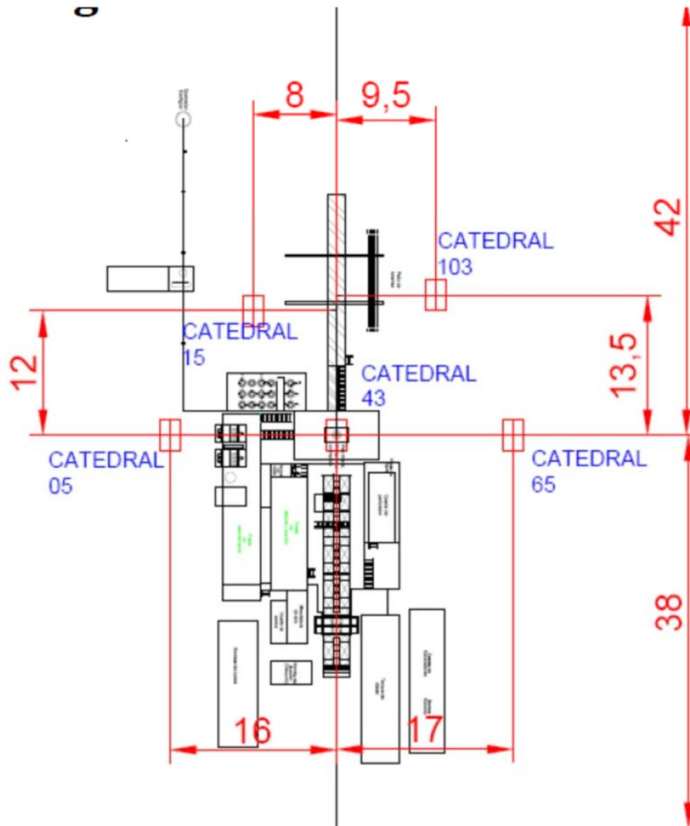
FIGURA III.1.3.1 DIMENSIÓN DEL EQUIPO DE REPARACIÓN EN EL ÁREA DEL POZO C-43
