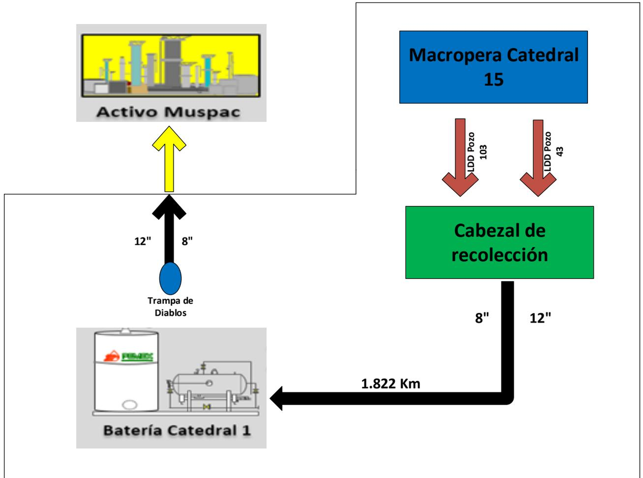
**FIGURA III.1.10.1 DIAGRAMA GENERAL DE FLUJO DE PROCESO DE LA MACROPERA 15 PARA EL POZO 43**
