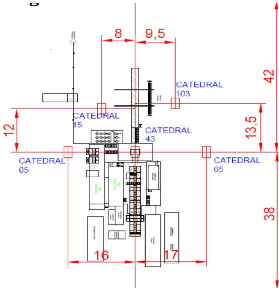
**FIGURA III.1.3. DISTRIBUCIÓN DE EQUIPO DE REPARACIÓN EN EL ÁREA DEL PROYECTO (PERA 15 PARA EL POZO C-43)**
