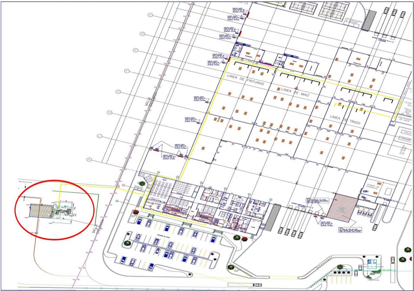
**Nota:** La única obra civil considerada es la plancha de concreto armado que se construyó para asentar ahí la estación de descompresión, así como en el área de estacionamiento destinadas a los tráileres (contenedores) y la construcción de la barrera perimetral conformada por malla ciclónica.
