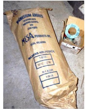
La fuente de corriente de este sistema utiliza la diferencia de potencial de oxidación entre el material del ánodo y la tubería. La protección de las tuberías se produce a consecuencia de la corriente que drena el ánodo durante su consumo. Toda la protección catódica se realizará de acuerdo a la norma **NOM-007-SECRE-2010**.
