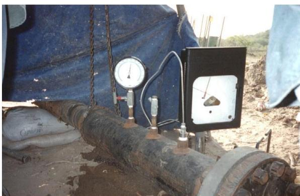
*A toda la tubería será necesario realizar pruebas hidrostáticas. La prueba de hermeticidad puede ser con agua o gas inerte (N<sub>2</sub>).*
