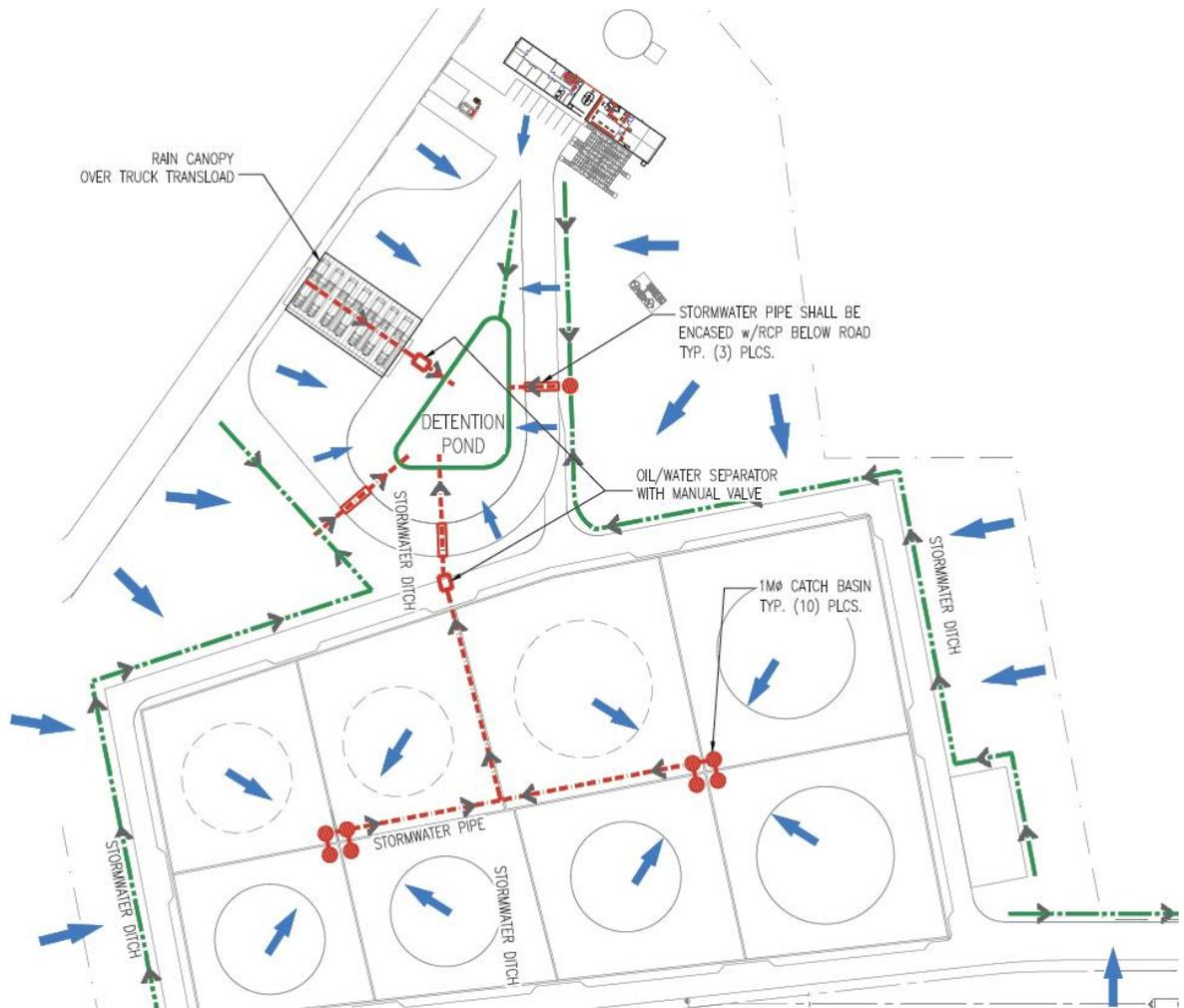
**V.2.4.C. Drenaje pluvial y aceitoso en las áreas de: tanques de almacenamiento, estación de carga de autotankes, oficinas, trasvase.**
