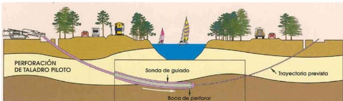
Ilustración 5.- Esquema de Perforación Guía.
