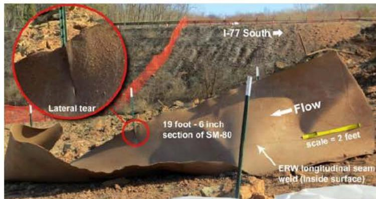
Ilustración 16. Parte del ducto eyectado a presión.
