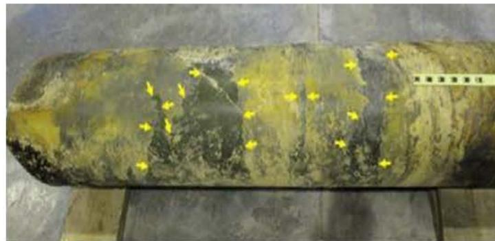
La diferencia de corrosiones a lo largo del tubo se debe a que ni el revestimiento no se hizo de manera adecuada ni la protección catódica.
