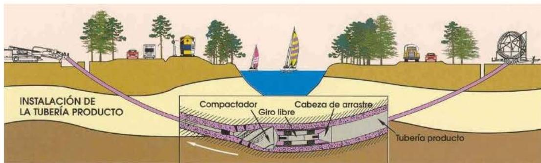
Ilustración 7.- Esquema de Instalación de Tubería.
