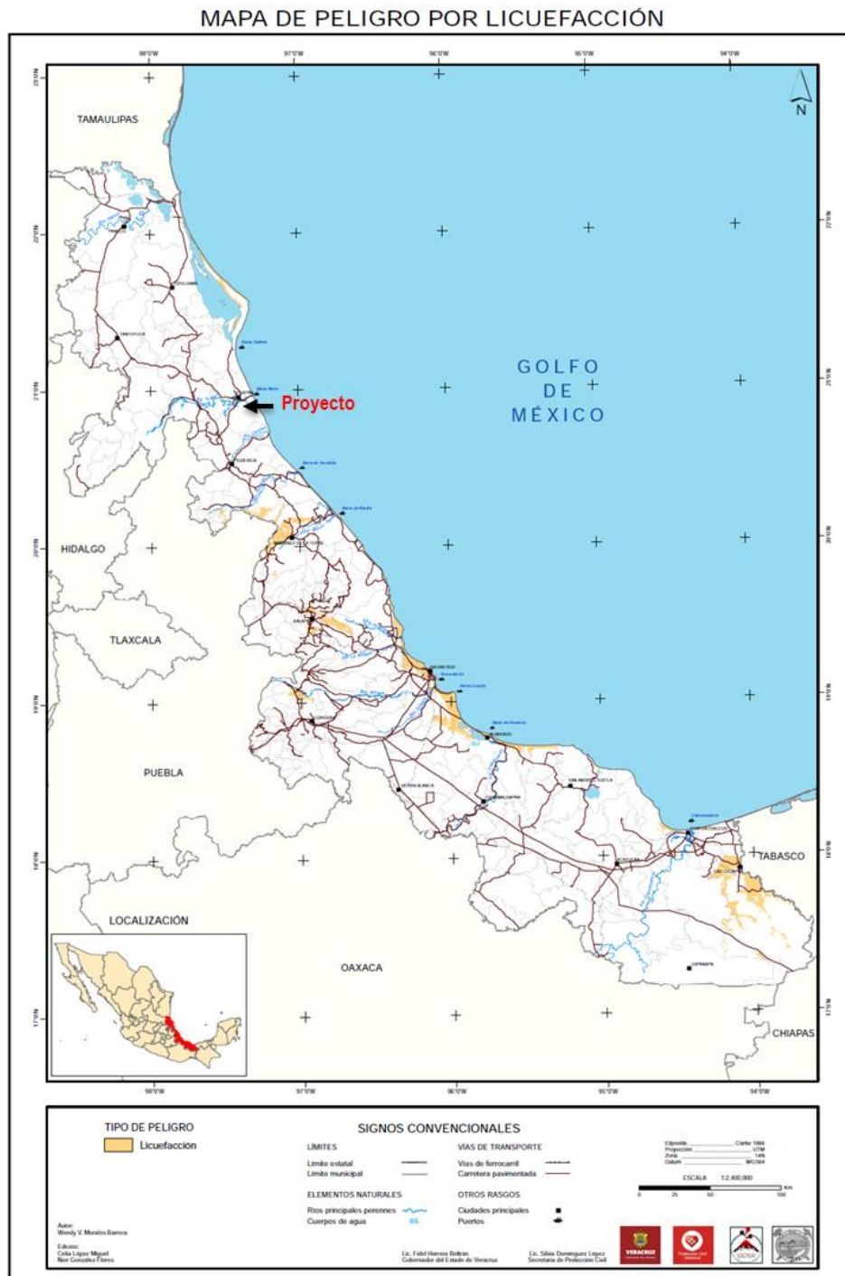
Figura I-5. Peligros por licuefacción.
