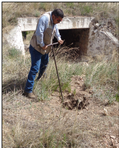
7. Se tomaron muestras a diferentes profundidades con ayuda del Hand Auger.
