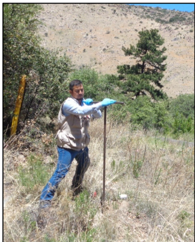
3. Con ayuda del Hand Auger de acero inoxidable se tomaron muestras en el área afectada.
