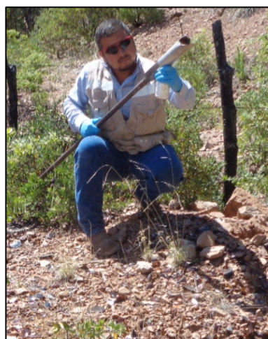
10. Cada muestra fue envasada en frascos de vidrio con tapa de rosca y contratapa de teflón.
