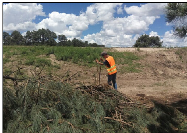
12.- Se realizaron sondeos en el área afectada.
