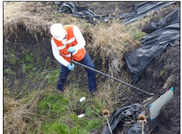
4.- Se tomaron muestras en las paredes de la fosa de excavación.
