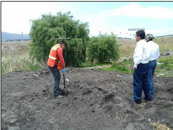
11.- Toma de muestra en celda provisional a una profundidad de 0.50 m.
