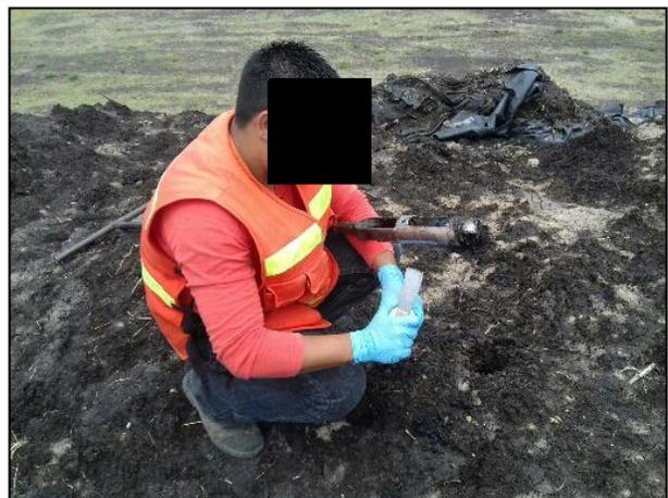
6.- Toma de muestra en celda provisional a una profundidad de 0.30 m.
