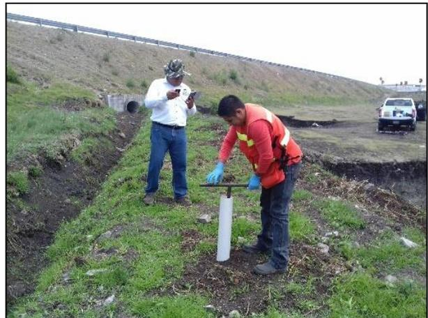
4.- Toma de muestra en fondo de la fosa de excavación (caja de extracción) con hand auger en el sitio dañado por el derrame de Combustóleo.
