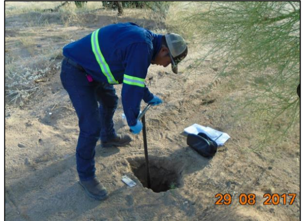
8 – Se tomaron muestras en la periferia de la fosa de excavación a diferentes profundidades con ayuda del Hand Auger.
