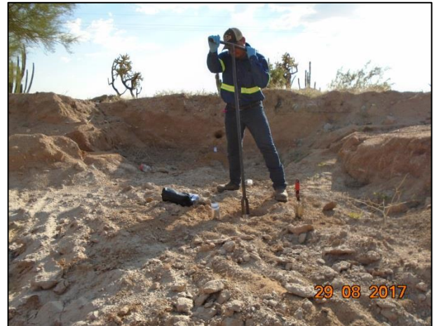
4 – Se tomaron muestras en el fondo de la fosa de excavación.
