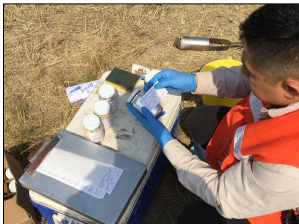
5. Etiquetado y sellado de muestras.
