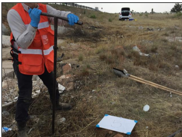
11. Toma de muestra con Hand Auger en el área afectada.
