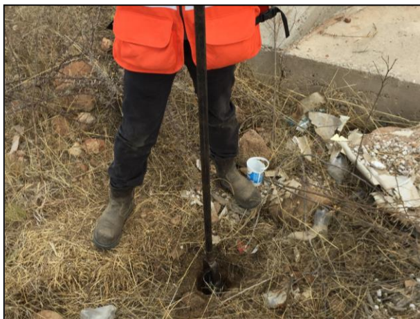
10. Toma de muestra con apoyo de Hand Auger.
