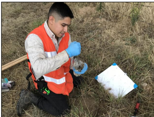
9. Envasado de muestra en frascos de vidrio.
