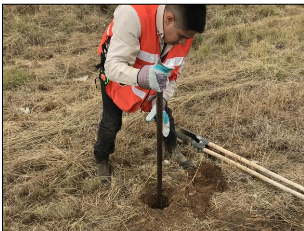
12. Con ayuda del Hand Auger se tomaron muestras a diferentes profundidades.
