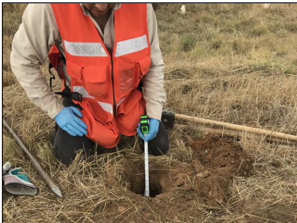
7. Con ayuda de flexómetro se midió la profundidad de cada muestra.
