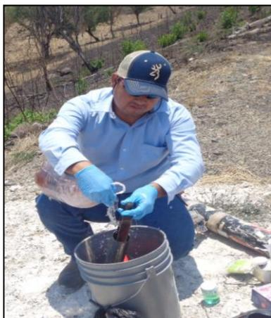
11.- Entre cada toma de muestra se lavó el equipo utilizado para mantener el buen aseguramiento de la calidad de las muestras.
