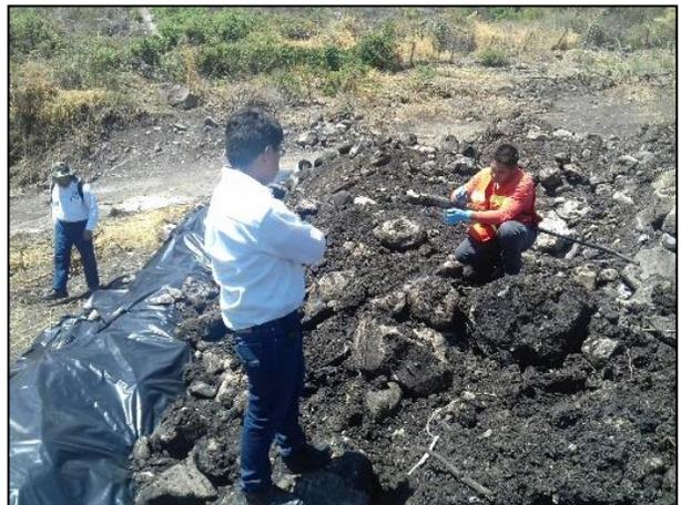
6 – Se tomaron muestras en el suelo afectado depositado en la Celda Provisional. La toma de muestras se realizó en presencia de personal de la ASEA.
