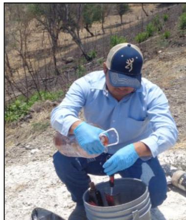
10.- Entre cada toma de muestra se lavó el equipo utilizado para mantener el buen aseguramiento de la calidad de las muestras.
