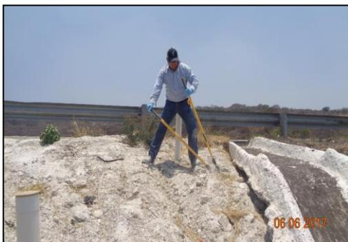
3.- Se realizaron los posos en los puntos de muestreo donde se tomaron las muestras de suelo en Fosa de Excavación (Fondo).
