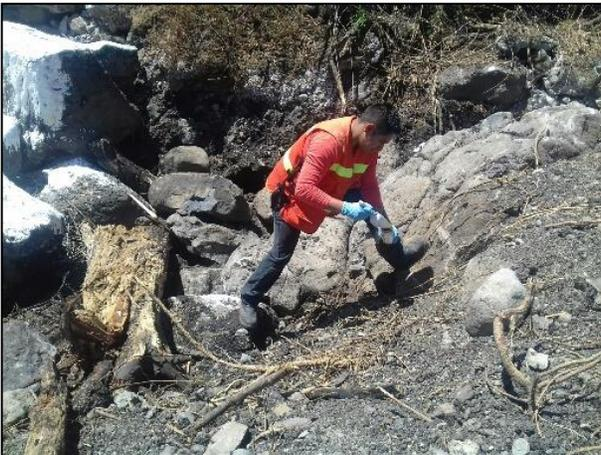
3 – Se tomaron muestras en las paredes de la Fosa de Excavación.
