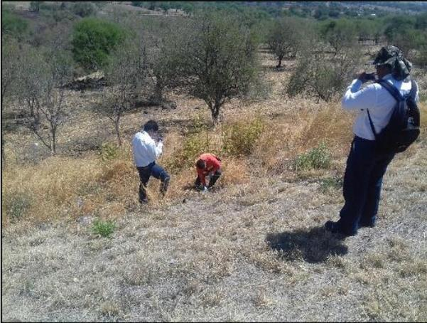
1 – Se tomó la muestra testigo con cucharón de teflón fuera del área afectada.
