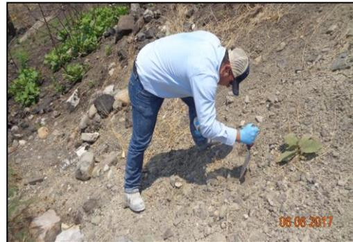
2.- Con espátula de acero inoxidable se tomó la muestra del Relleno utilizado en la Fosa de Excavación (Área 1 – Meseta).
