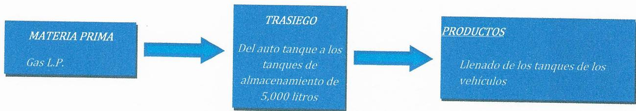
Diagrama de flujo de descarga de Gas L.P. de carro remolque a tanques de almacenamiento
