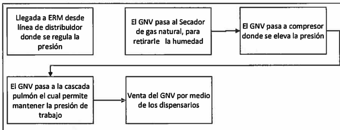
Figura 45. Diagrama de Flujo de Operación de la Estación de Servicio de GNV.
