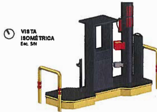
Figura 43. Surtidores de gas en disposición longitudinal.
