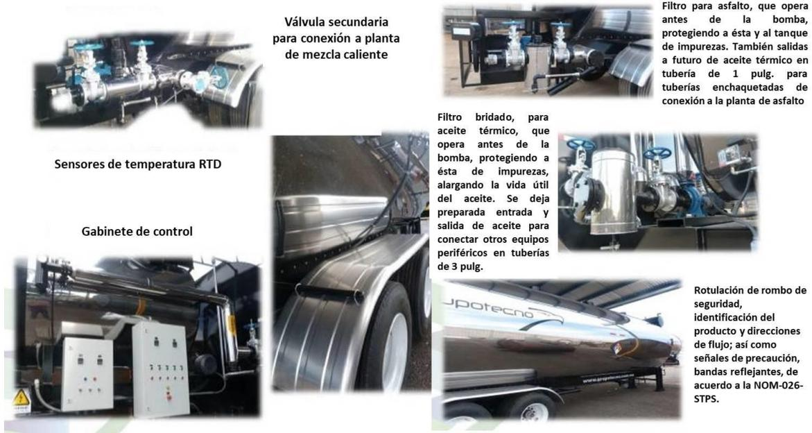
Figura 14. Principales características del Tanque móvil de almacenamiento de asfalto Modelo TGM PRI 100 CC (tomado de las especificaciones del proveedor).
