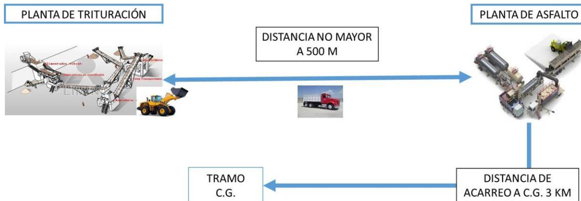
Figura 3. Consideraciones para la toma de decisiones acerca de la ubicación del sitio del proyecto, en función a las distancias para el acarreo de material al frente de trabajo.
