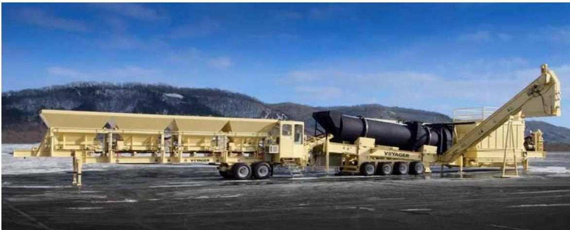
Fotografía 5. Planta de asfalto portátil Voyager 120.
