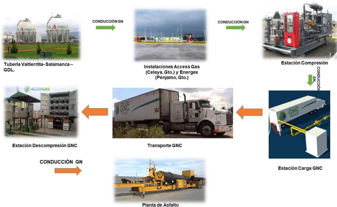
Figura 28. Diagrama del proceso de compresión, transporte y descompresión de gas natural, proporcionado por el proveedor (puede verse video: <https://youtu.be/-3jtFwlyV6M>).
