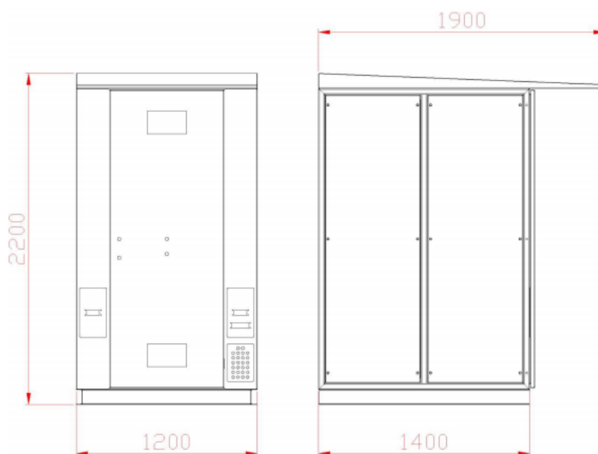
Ilustración 8 Tablero de Control (mm)
