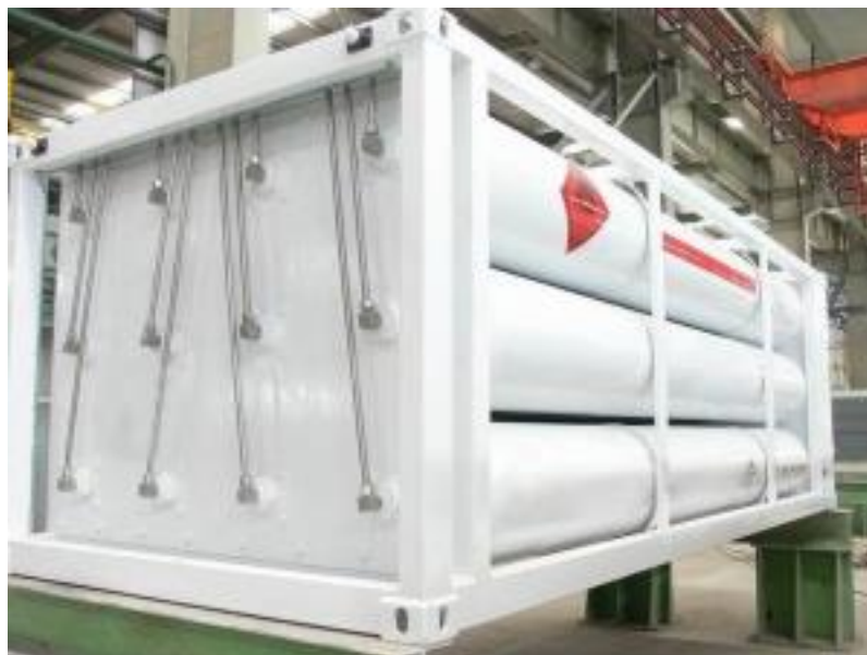
Ilustración 10. Cilindros para el suministro de GNC
