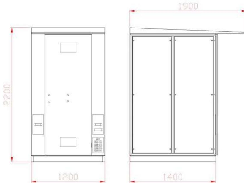
Ilustración 8. Tablero de Control (mm)
