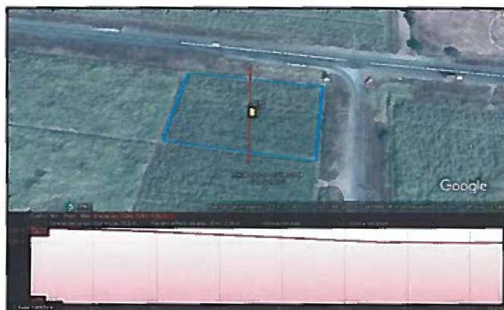
**Figura 40.** Perfil de elevaciones en dirección norte-sur en el sitio del proyecto.
