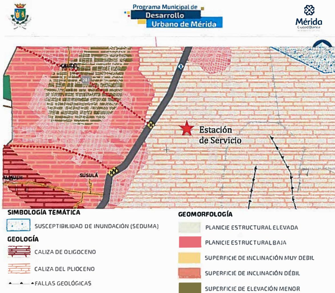
El intemperismo está representado principalmente por fenómenos químicos que producen disolución de la caliza, mediante una acción que se denomina kárstica y que es causante de un gran número de conductos y cavidades subterráneas comunicadas entre sí y ocasionalmente al exterior.
