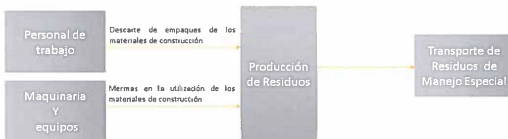
Figura 3.9: Fuente de generación y forma de manejo de los residuos de manejo especial que se generarán en la etapa de preparación y construcción del sitio.
