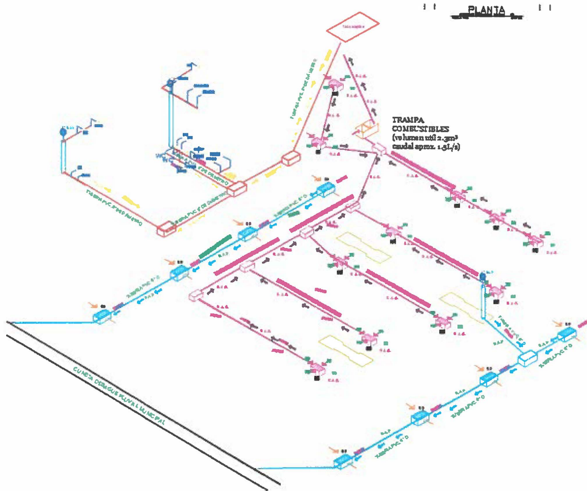
Figura III.20. Isométrico instalación de drenajes
