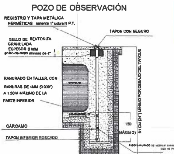
Figura III.13. Detalle pozo de observación.
