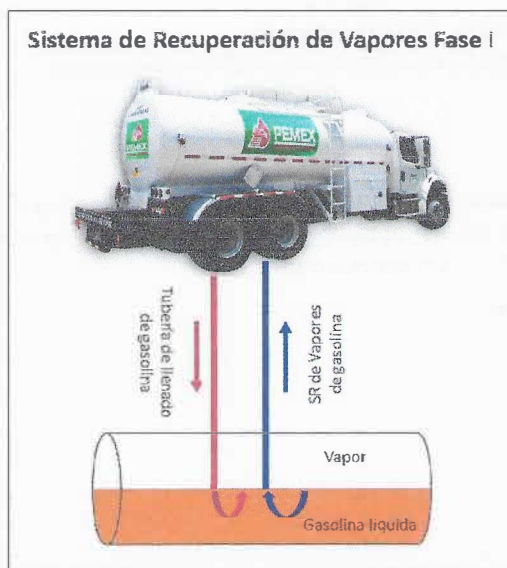
Figura 3: Sistema de Recuperación de Vapores Fase I
