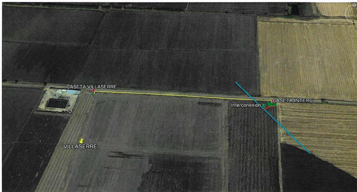
Ducto de 6" y 4" de diámetro nominal Acero API 5L X42, 0.188" de espesor (por construir).
