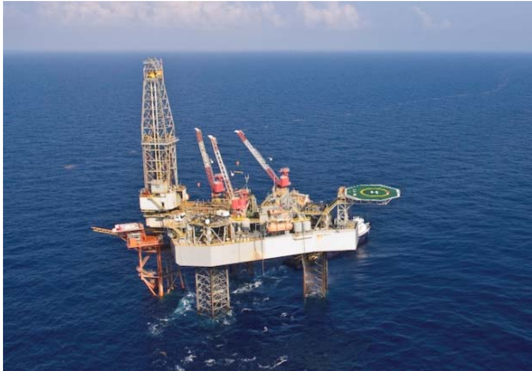
Figura 2.5 Esquema de una UMP auto-elevadiza o “Jack-up” ENSCO 75 (Cortesía de ENSCO)
