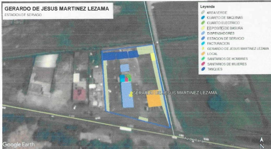
ILUSTRACIÓN 9 PLANO DE DISTRIBUCIÓN DE LA ESTACIÓN DE SERVICIO
