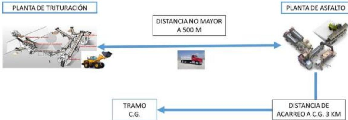
**Figura 4 Consideraciones para la toma de decisiones acerca de la ubicación del sitio del proyecto en función a las distancias para el acarreo de materiales al frente de trabajo**
