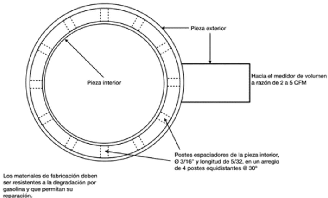
Figura 1. Captador de vapores, vista de planta.
