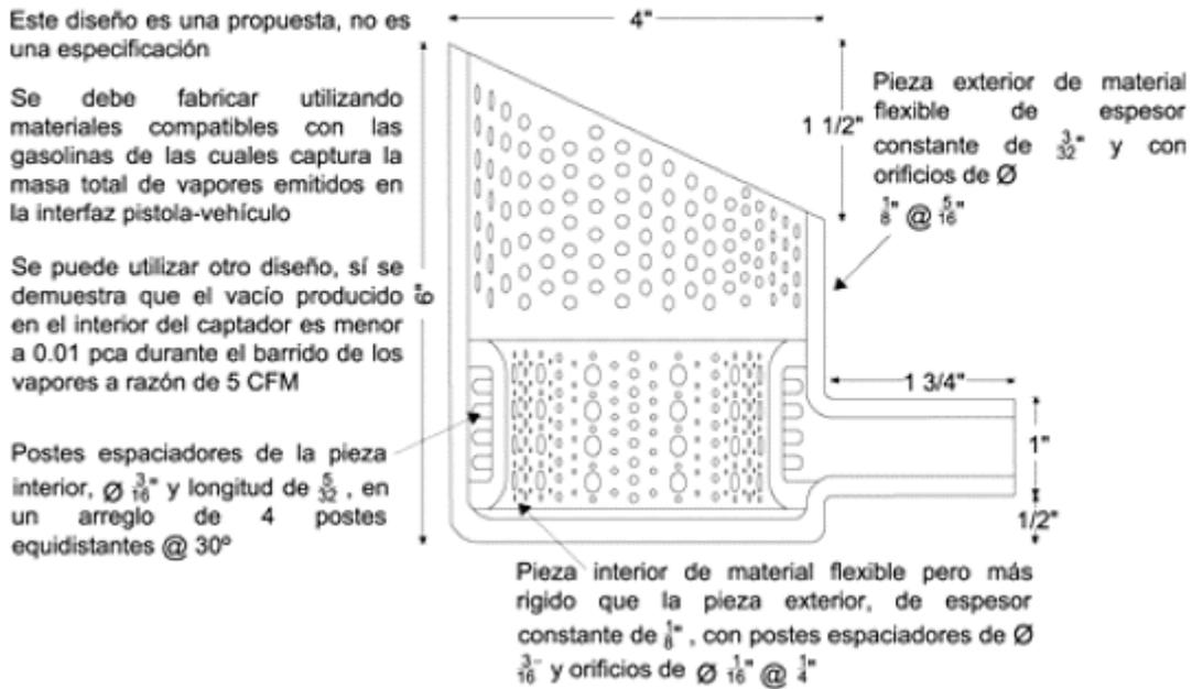
Figura 2. Captador de vapores, vista de sección.
