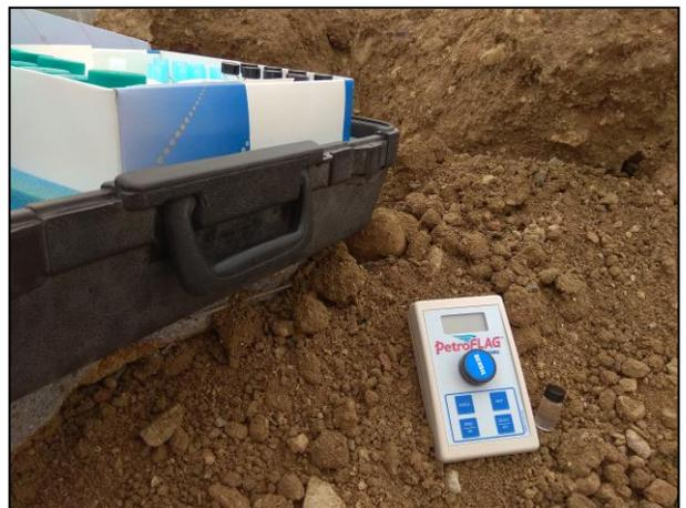
6.- Antes de iniciar los trabajos de extracción, se analizaron muestras con ayuda del equipo PetroFlag, para delimitar el área afectada.
