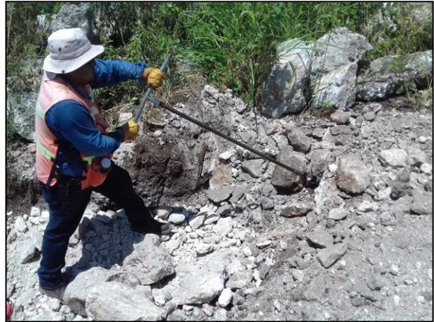
2 – Con ayuda de Hand Auger se tomaron muestras en las paredes de la fosa de excavación.
