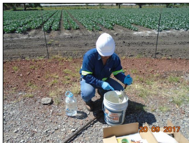
2 – Se lavó el equipo entre cada toma de muestras para evitar la contaminación cruzada durante la toma de muestras.
