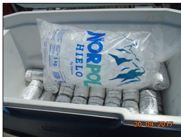
12 – Las muestras se preservaron con hielo a 4° C para su posterior análisis.
