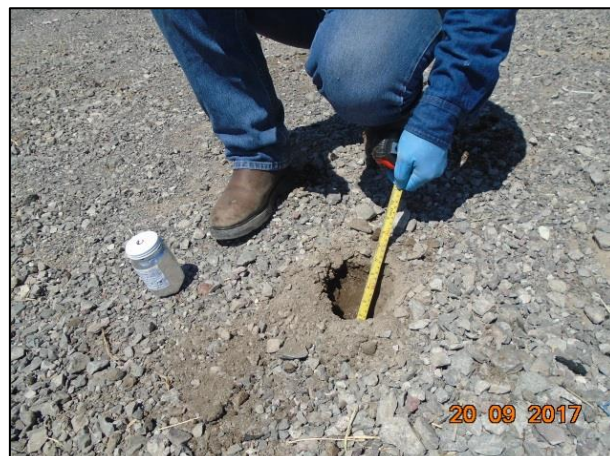
4 – Se tomaron muestras a diferentes profundidades, registrando la profundidad de las mismas.
