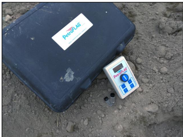
7.- Antes de iniciar los trabajos de extracción se analizaron muestras con ayuda del equipo PetroFlag, para delimitar el área afectada.
