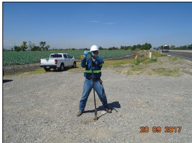
3 – Se tomaron muestras a diferentes profundidades con ayuda del Hand Auger. Toma de muestras en el área de retiro de material
