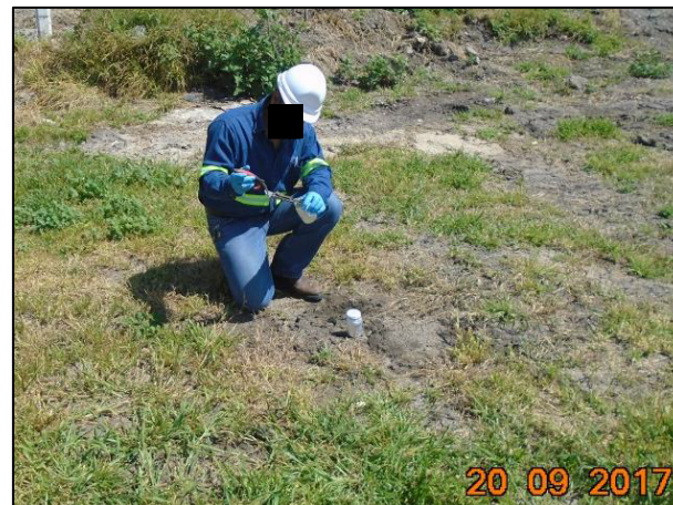
10 – Se tomaron muestras superficiales en el área afectada con ayuda de la espátula de acero inoxidable. Toma de muestra testigo.
