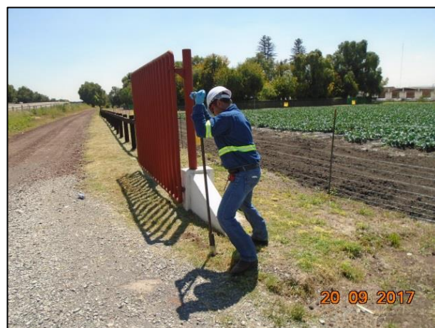
6 – Con ayuda de Hand Auger se tomaron muestras en el área afectada por el derrame de Combustóleo.
