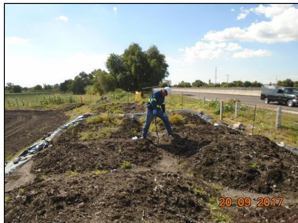
9 – Con ayuda del Hand Auger se tomó muestra en la celda provisional.
