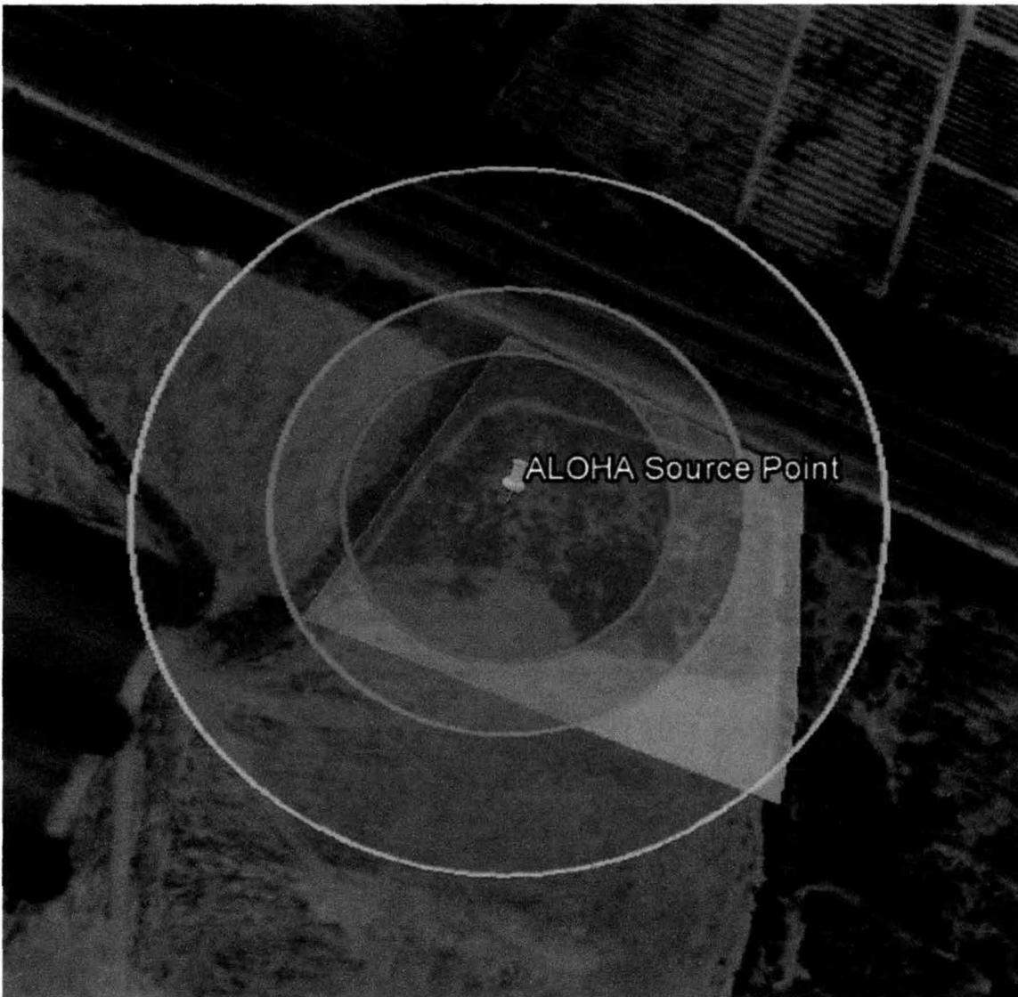
**Imagen 5. Radios de afectación por autotanque de gasolina magna**
