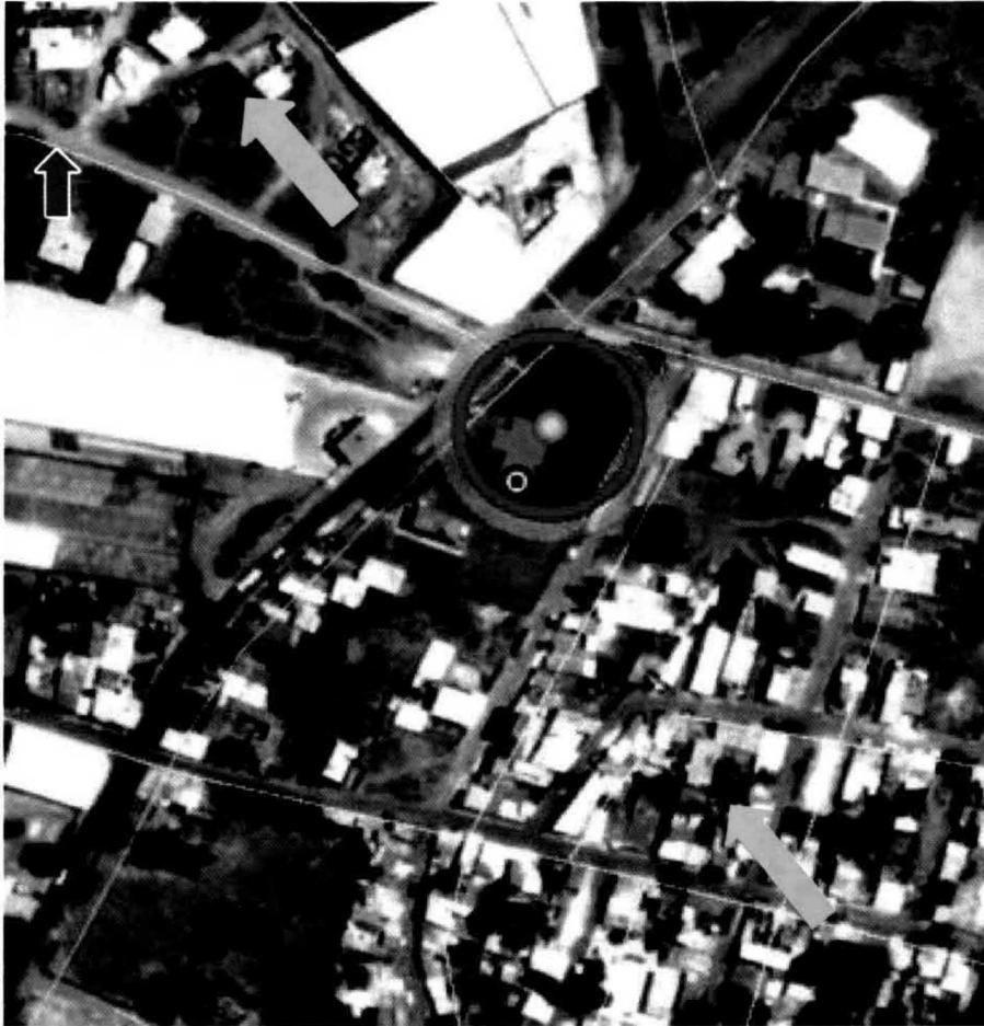
Figura 25. Área de afectación por una dispersión de una nube de gasolina vaporizada en la zona de dispensarios en condiciones C con un viento de 2.22 m/s, el área de afectación por los vientos dominantes es al Noroeste (flechas amarillas), donde la afectación es en el interior de la estación y las construcciones vecinas, como la Calle Galeana y Guadalupana.
