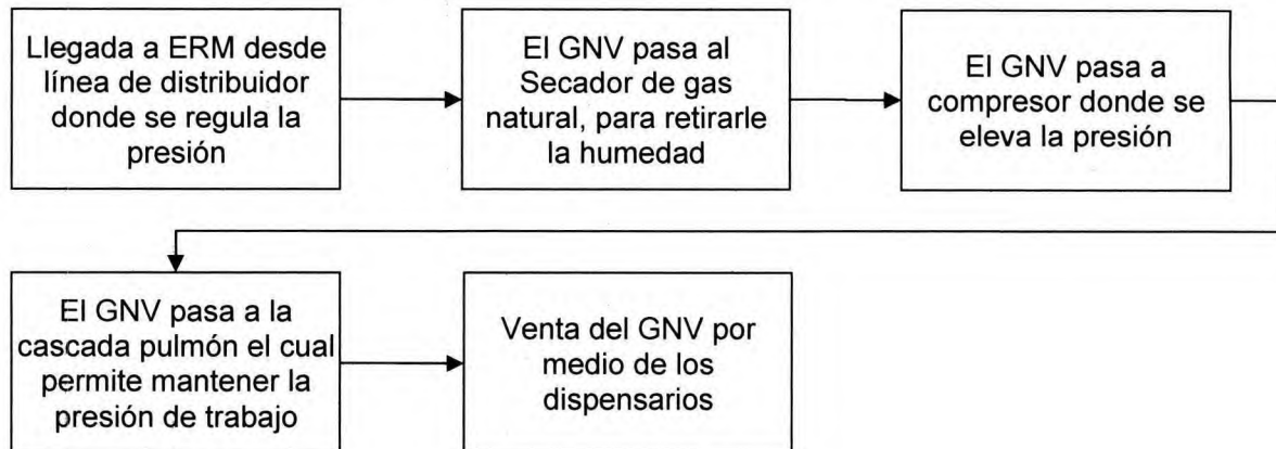
Figura. Diagrama de Flujo de operación de la estación de GNV
