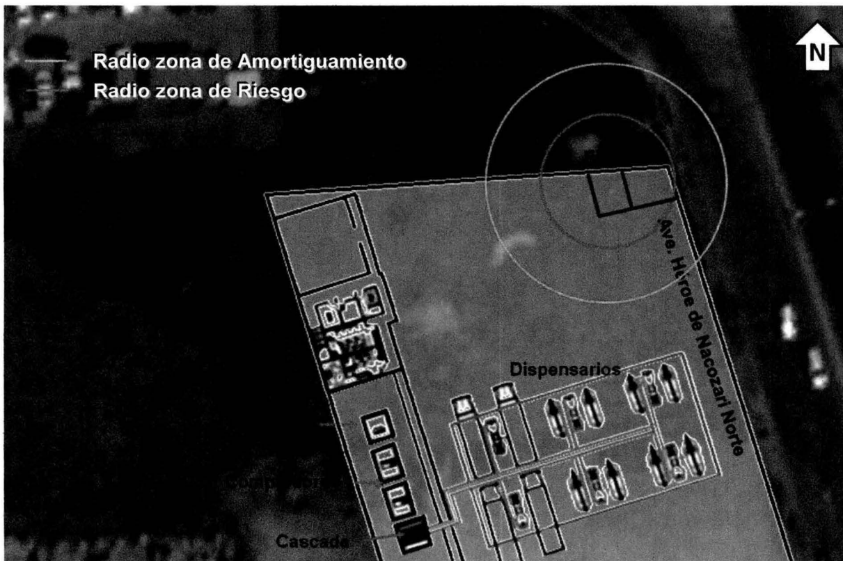
Figura 22. Radios de zona de riesgo y amortiguamiento por incendio de gas (Escenario 1)
