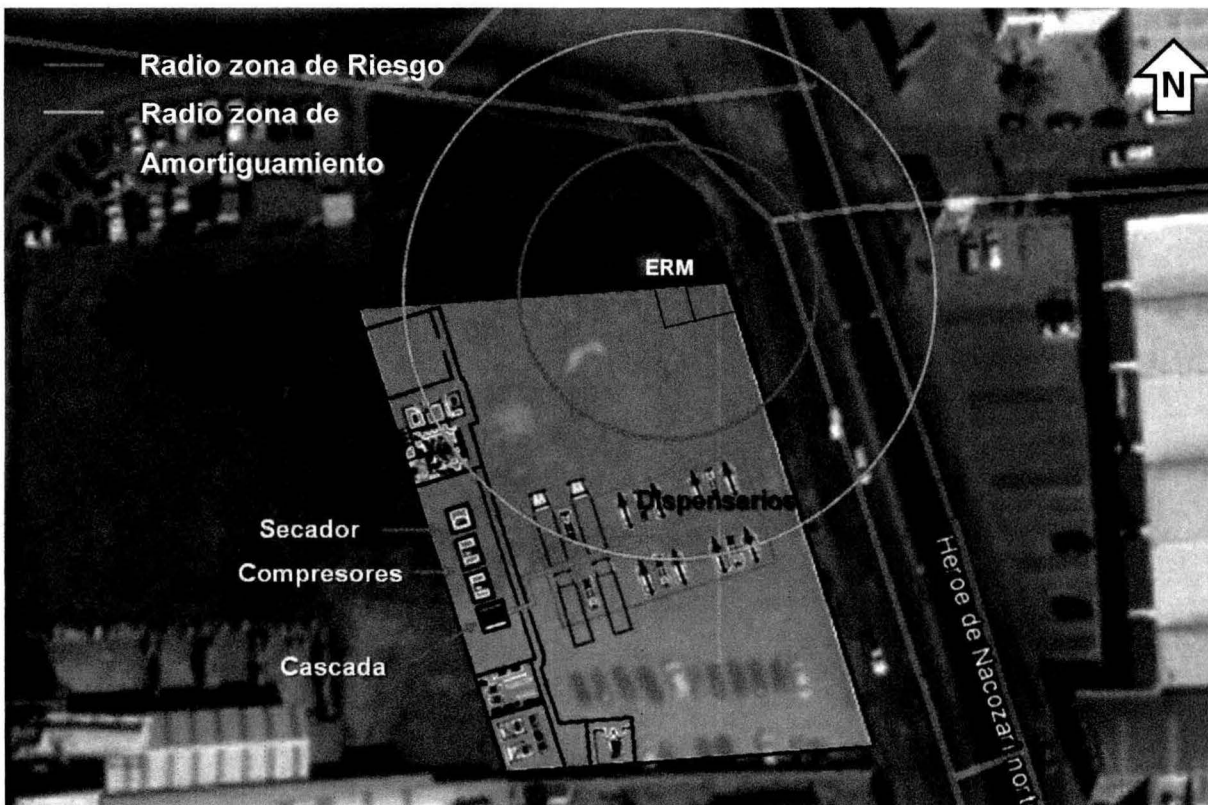
Figura 25. Radios de zona de riesgo y amortiguamiento por incendio de gas (Escenario 2)
