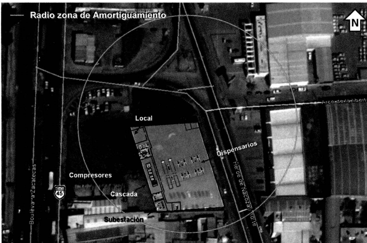
Figura 24. Radios de zona de amortiguamiento por explosión de nube de gas (Escenario 2)
