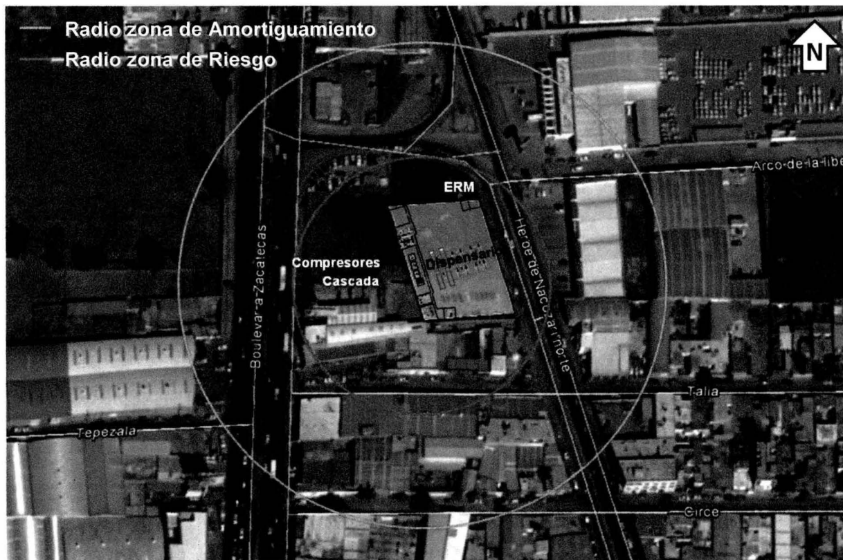
Figura 29. Radios de zona de riesgo y amortiguamiento por incendio de gas (Escenario 3)
