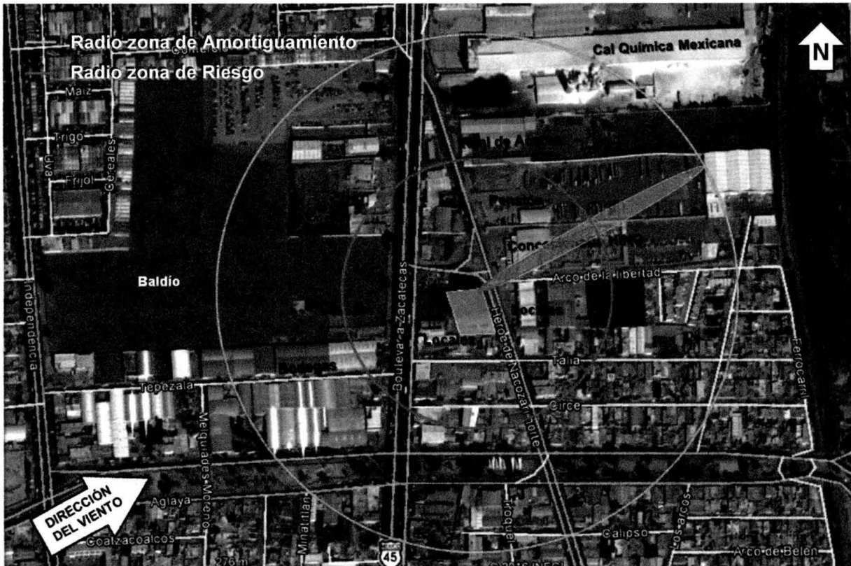
Figura 23. Radios de zona de riesgo y amortiguamiento por fuga de gas (Escenario 2)
