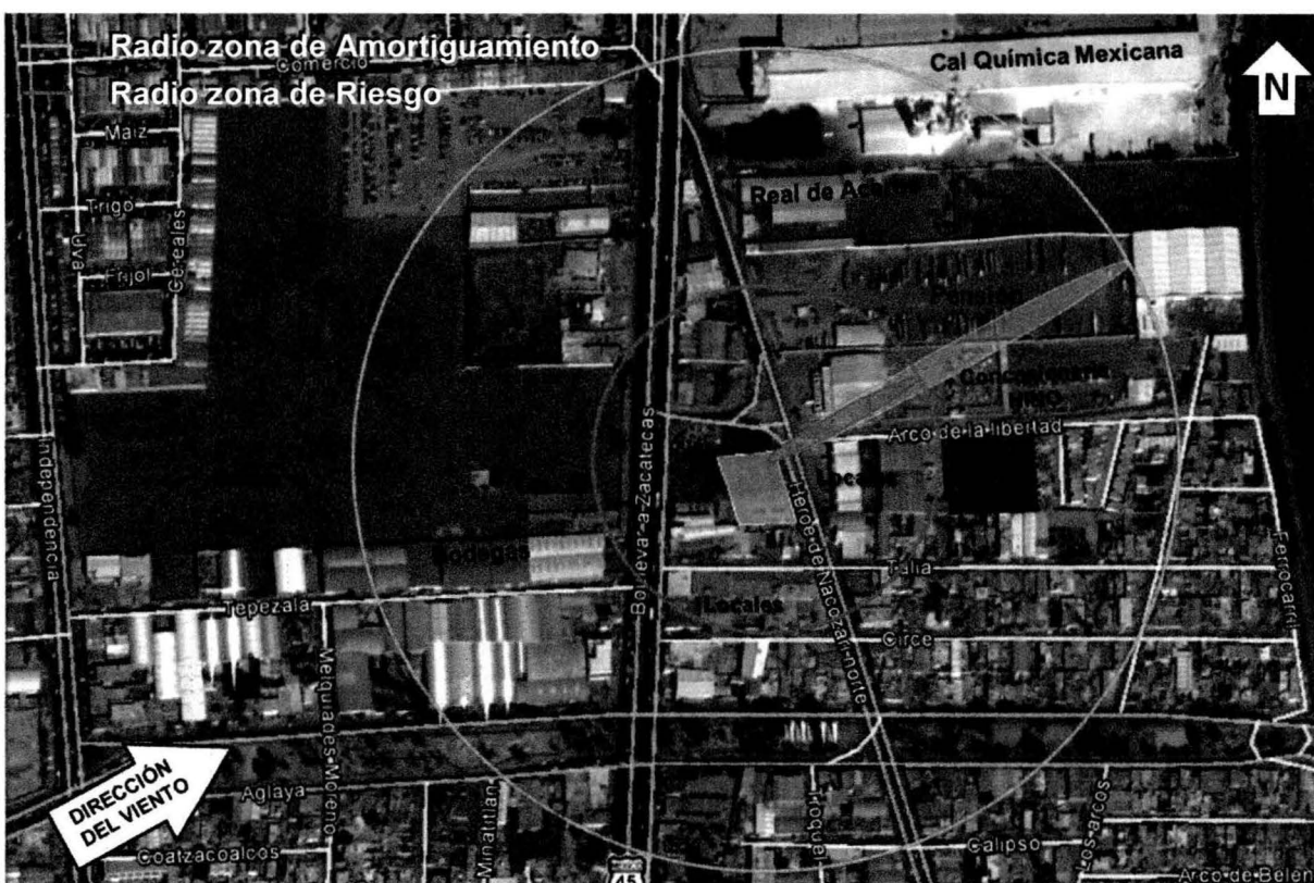
Figura 19. Radios de zona de riesgo y amortiguamiento por fuga de gas (Escenario 1)
