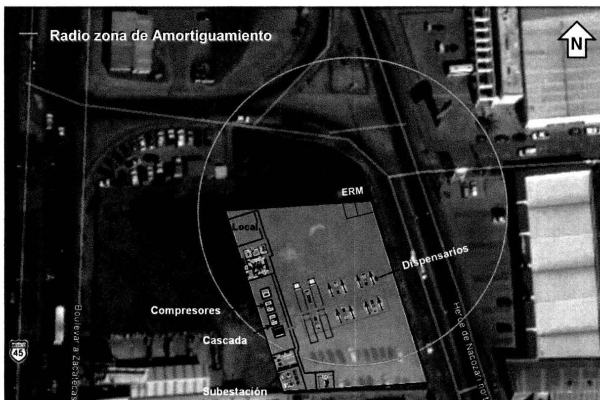
Figura 21. Radios de zona de amortiguamiento por explosión de nube de gas (Escenario 1)
