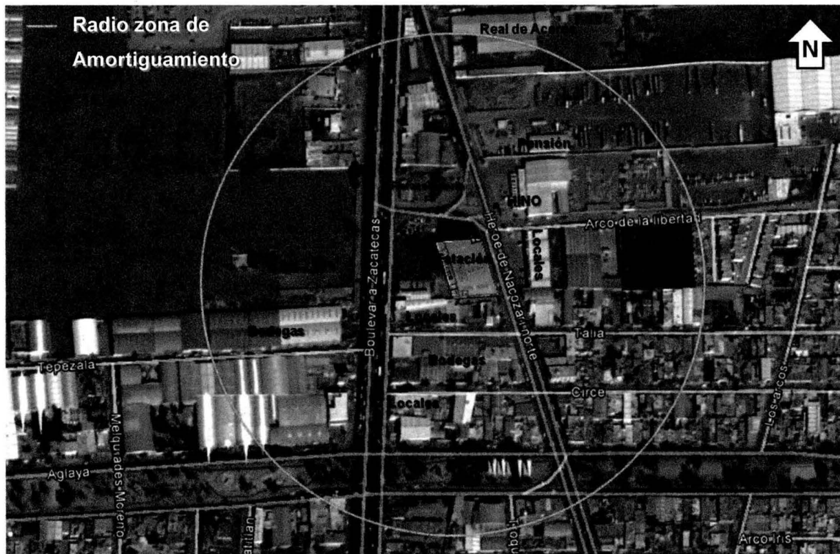
Figura 28. Radios de zona de amortiguamiento por explosión de nube de gas (Escenario 3)
