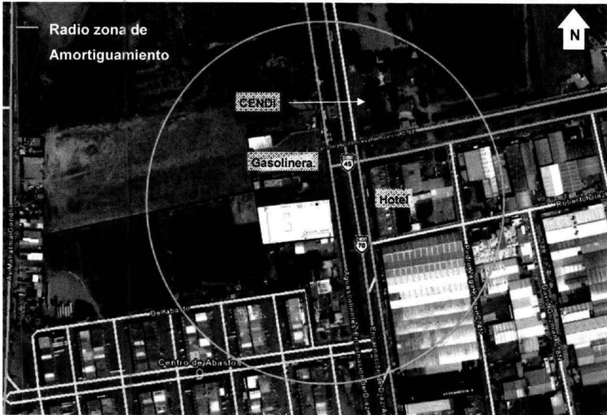
En caso de presentarse el incendio durante la fuga del gas, se tienen radios de 26 m para la zona de riesgo y 49 m para la zona de amortiguamiento, los cuales afectan principalmente a los otros equipos de la estación de servicio como son los compresores, la cascada de almacenamiento, los dispensarios y los locales comerciales.
