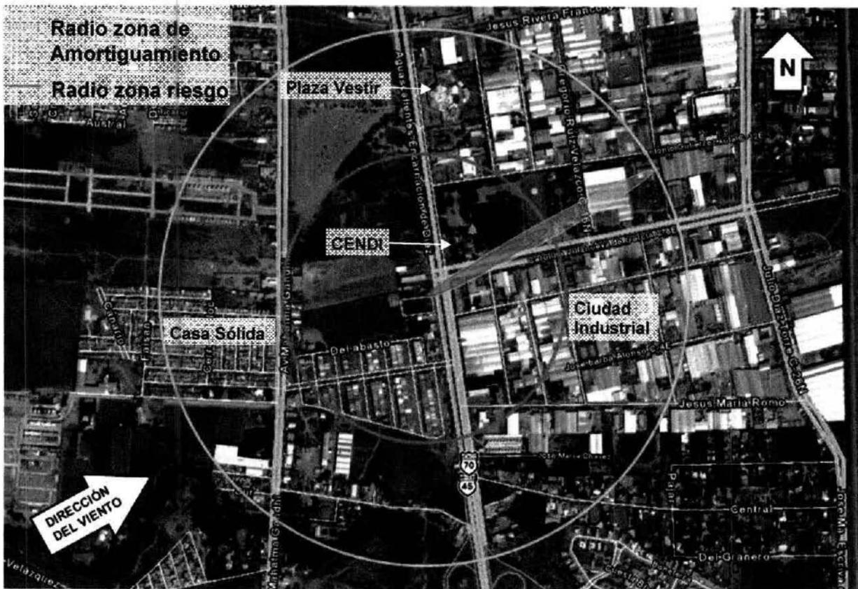
En este escenario, la concentración de gas natural al exterior en el punto a 80 m de distancia de la fuente (Hotel) alcanza hasta 340,000 ppm en un lapso muy breve de 1 minuto a aproximadamente a los 2 minutos de iniciada la fuga, para después de 3 disminuir por debajo del IDLH; en el caso de la concentración al interior no excede de 1200 ppm.
