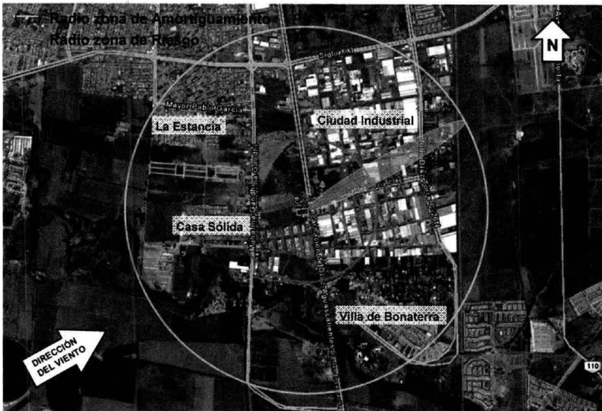
De igual forma que en el Escenario 1, se calculó la concentración del gas a 70 m de distancia en dirección del viento (ubicación del hotel), obteniéndose como resultado que la concentración máxima al exterior alcanza 34,900 ppm aproximadamente a los 2.5 minutos para descender hasta aproximadamente 16,000 ppm manteniéndose constante el resto del tiempo (considerando que la fuga no se detiene y permanece al menos por una hora); la
