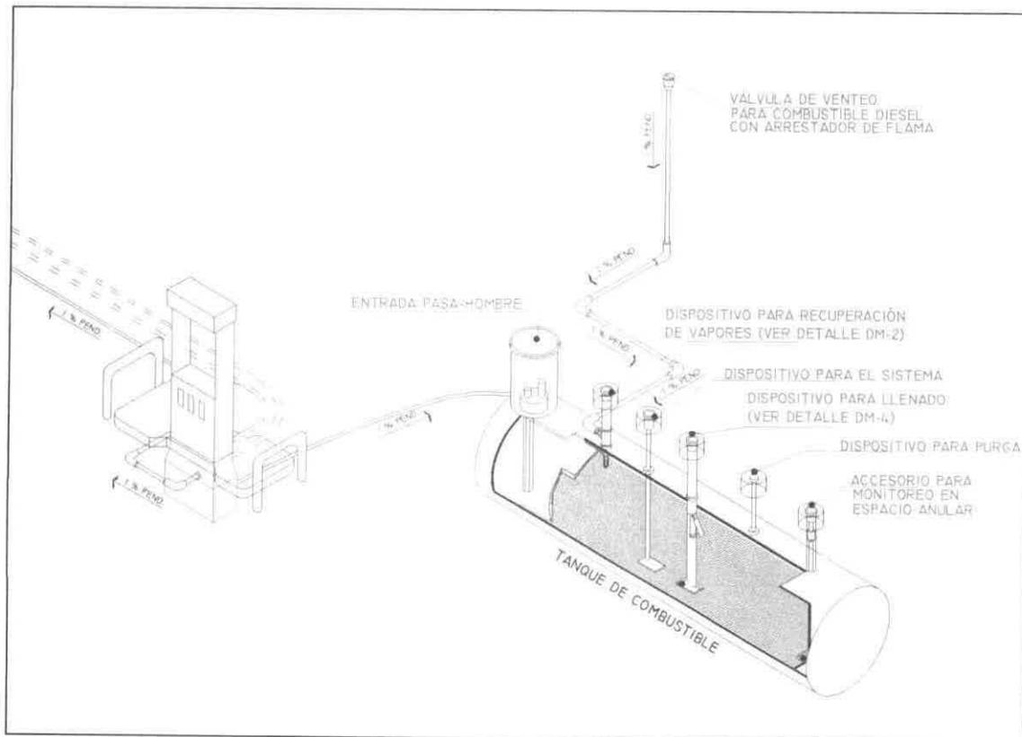
Imagen No. 27.- Dispositivos en el tanque de almacenamiento.
