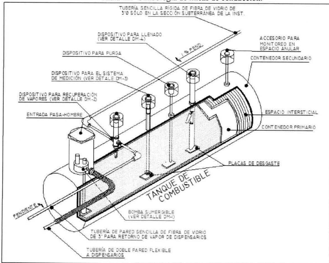
Imagen No. 28.- Detalles de Instalaciones en el tanque de almacenamiento.
