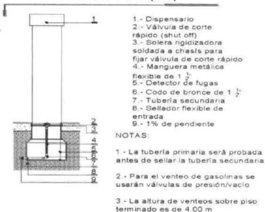
Figura 7. Corte transversal y longitudinal de los dispensarios de combustible
