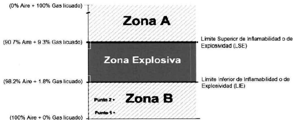
Punto 1 = 20% del LIE: Valor de ajuste de las alarmas en los detectores de mezclas explosivas.
