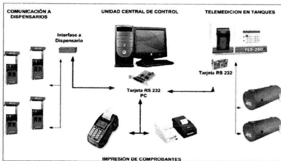
Imagen II.13. Equipos de control con que contará la gasolinera.
