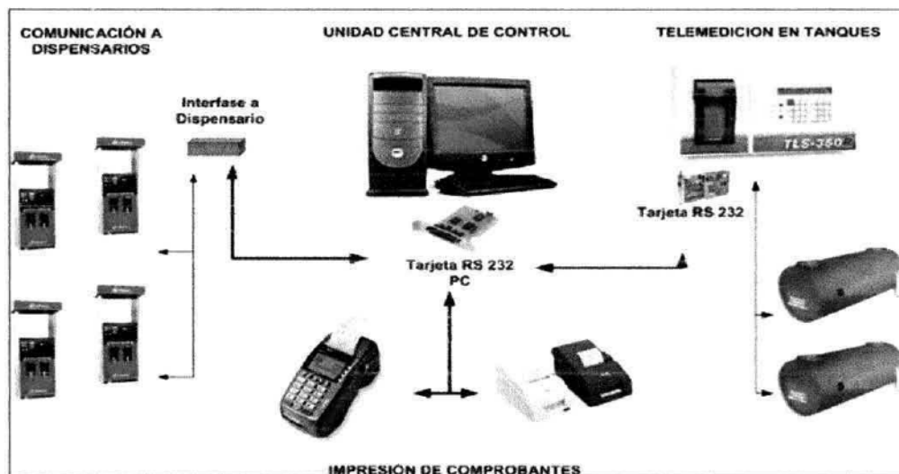
Imagen I.3. Equipos de control con que contará la gasolinera.
