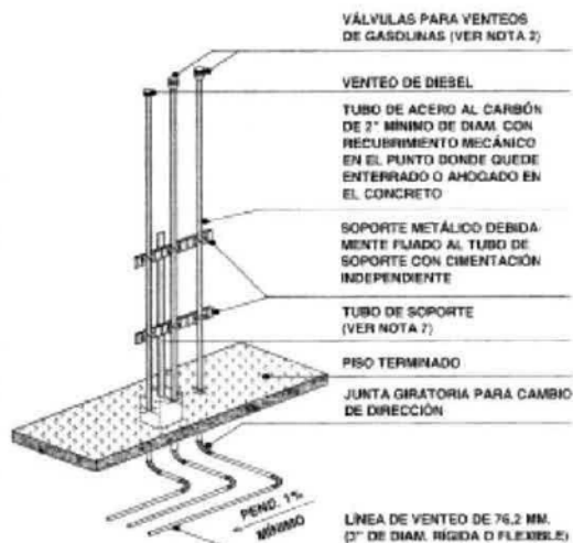
DETALLE DE VENTEOS CON SOPORTE METÁLICO INDEPENDIENTE
