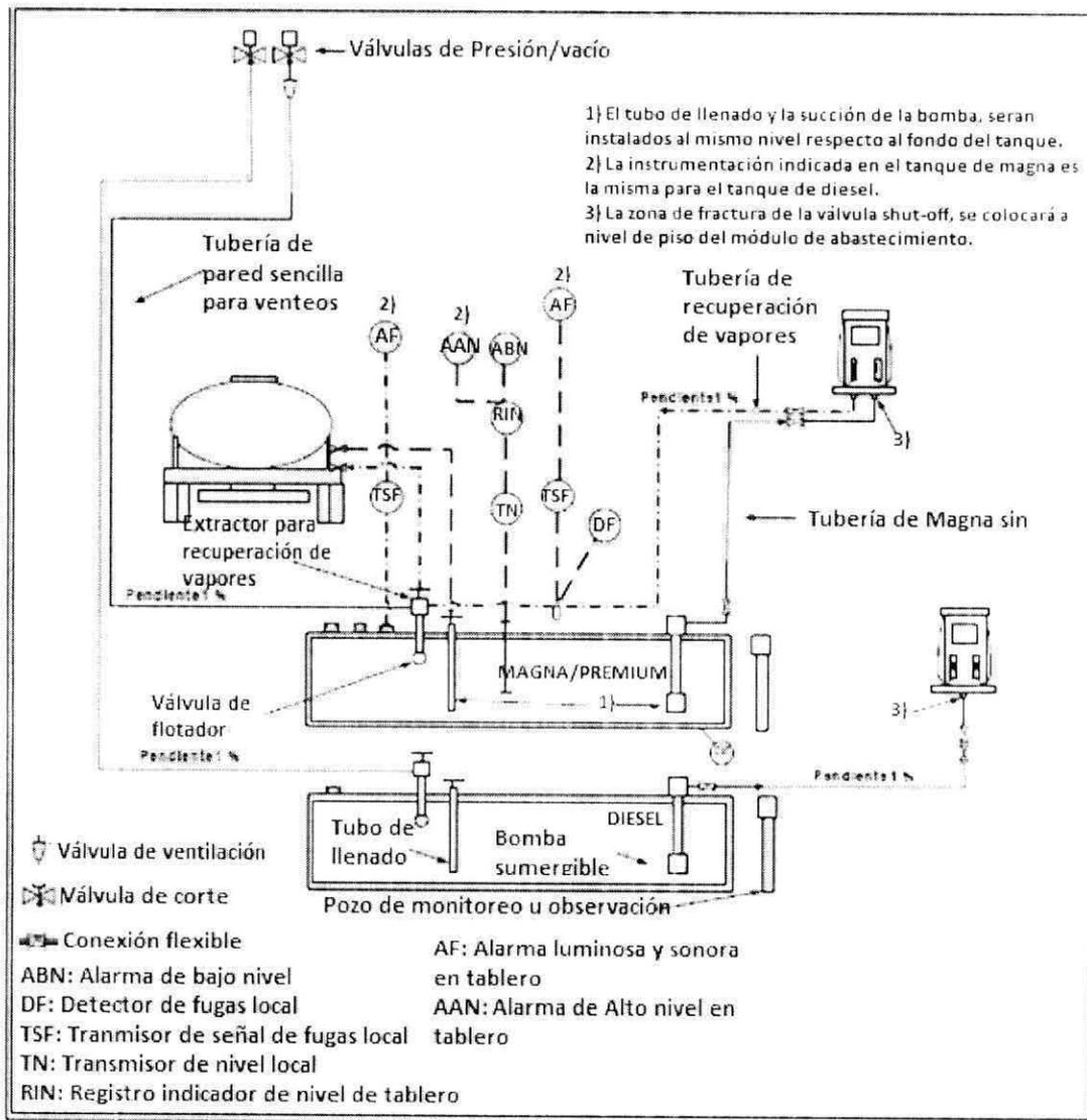
Imagen 2.8.- Diagrama de operación de la estación de servicio.
