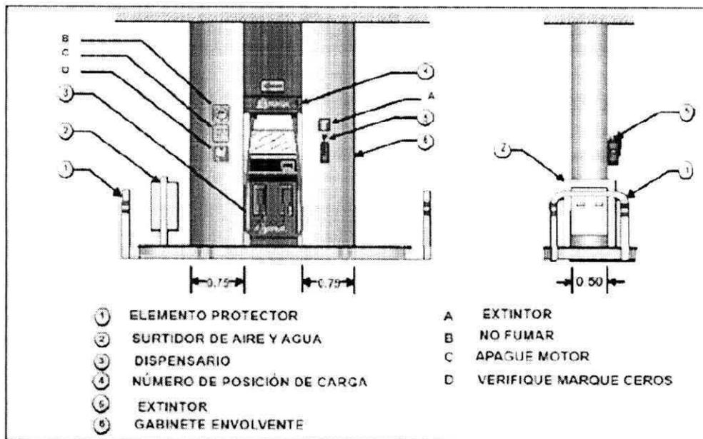
Imagen. 2.7.- Muestra de los distintos componentes de que consta cada una de las cuatro islas para el despacho de combustibles en la estación de servicio. Todo este equipamiento está adecuado a las especificaciones exigidas por PEMEX.
