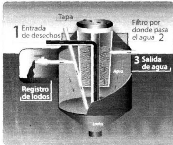
El uso de biodigestores para el tratamiento de aguas residuales, está sustituyendo los sistemas tradicionales como la fosa séptica, que constituyen riesgos de contaminación al agrietarse o saturarse, posee un sistema para la extracción de lodos o material digerido. Haciéndolo más higiénico, económico y amigable con el medio ambiente.
