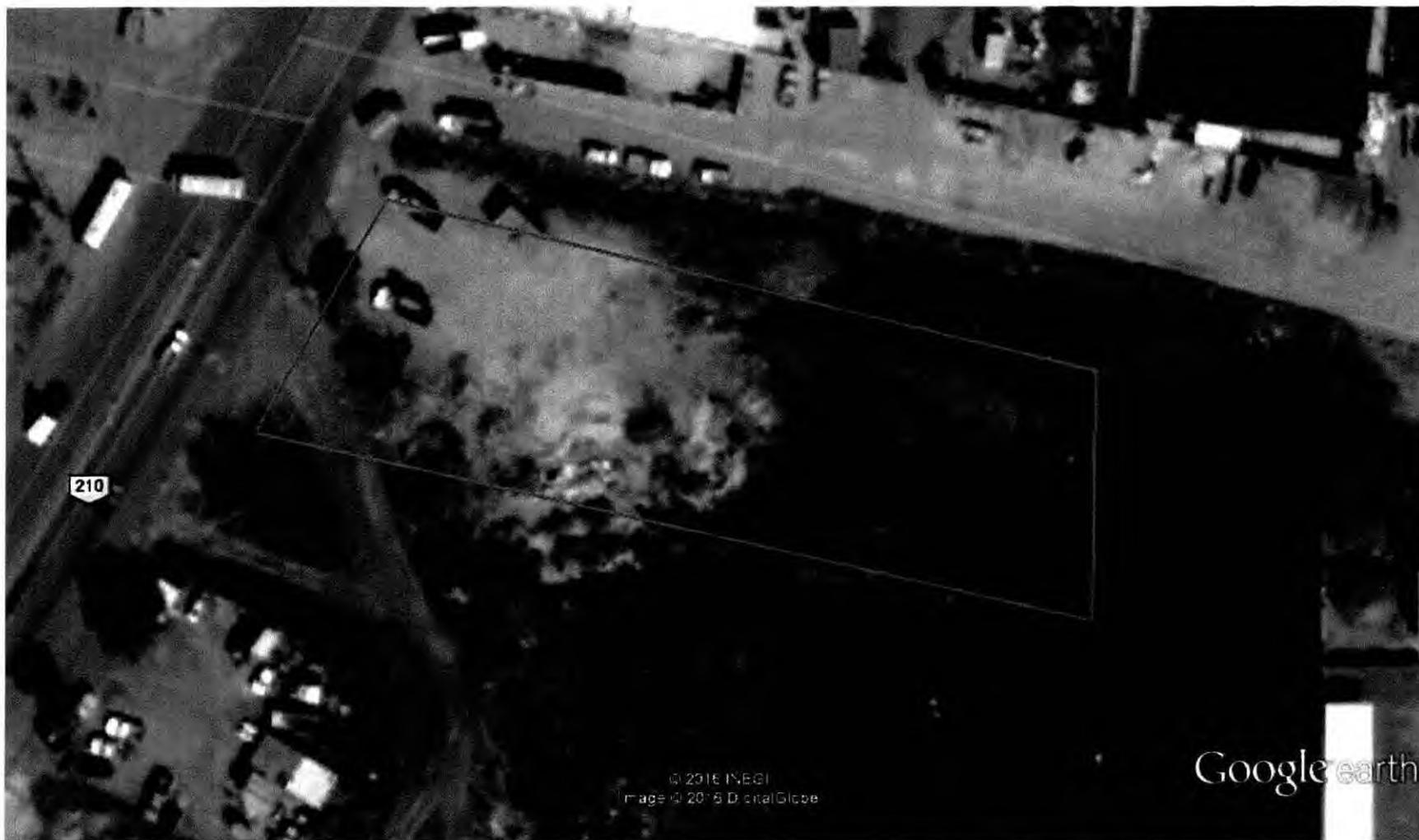
Predio del proyecto donde se tiene el punto de latitud  $20.577469^{\circ}$  N y Longitud  $100.255630$  W y con medidas al Norte  $94.17$  m, al Este  $31.93$  m, al Sur  $110.91$  m y al Oeste  $34.43$  m, esto con la Carretera Estatal 210 para dar una superficie de  $3,275.42$  m<sup>2</sup>.
