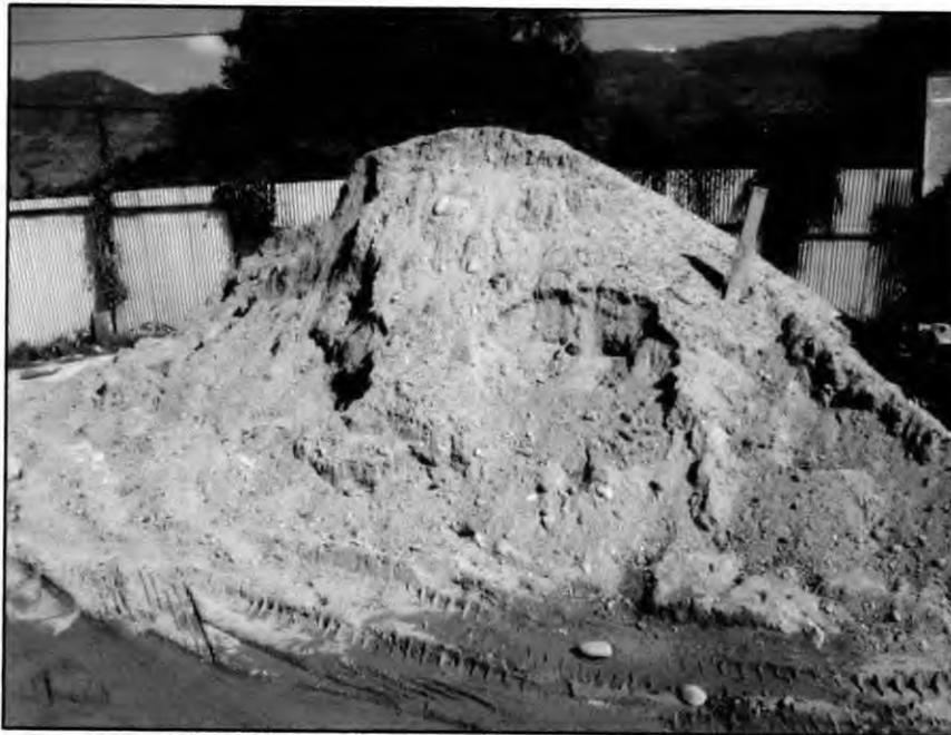
Foto 10. Montículo de arena que se utiliza para la elaboración de block.
