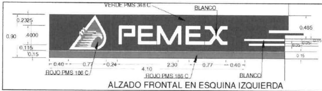
Imagen 2.5.- Faldón perimetral adosado a la techumbre, siguiendo los lineamientos y especificaciones de PEMEX.
